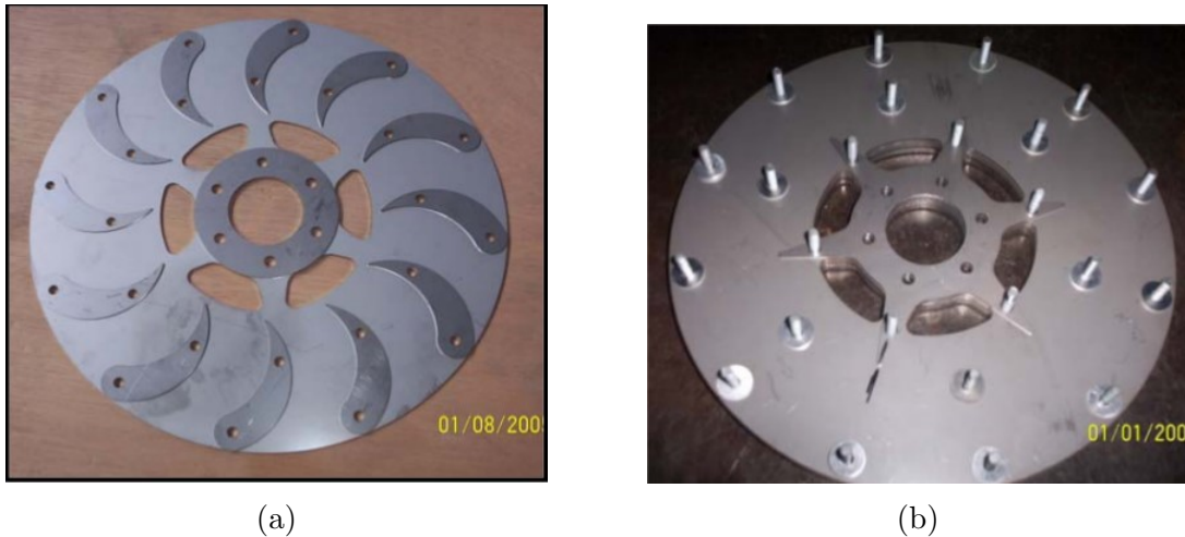
Figura 2.6: (a) Rodete Phoenix y (b) Rodete Tesla.
