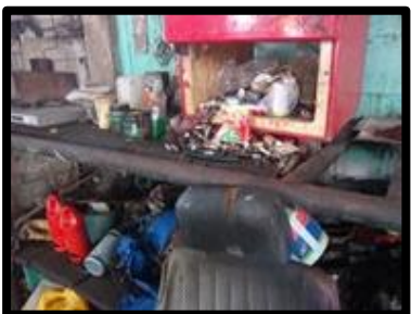
Figura 147 Almacenamiento inadecuado de productos químicos Taller Manolo Fuente: con base a la información obtenida
