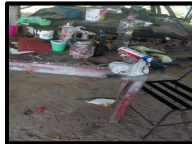
Figura 149 Almacenamiento inadecuado de productos químicos Taller Mil Años Fuente: con base a la información obtenida
