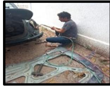
Figura 138 Soldadura autógena sin EPP Taller El Mosco Fuente: con base a la información obtenida
