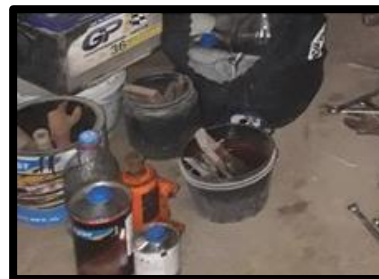
Figura 146 Almacenamiento inadecuado de productos químicos Taller Trino Fuente: con base a la información obtenida
