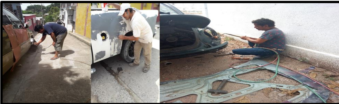
Figura 28 Aplicación de pintura, lijado y soldadura
