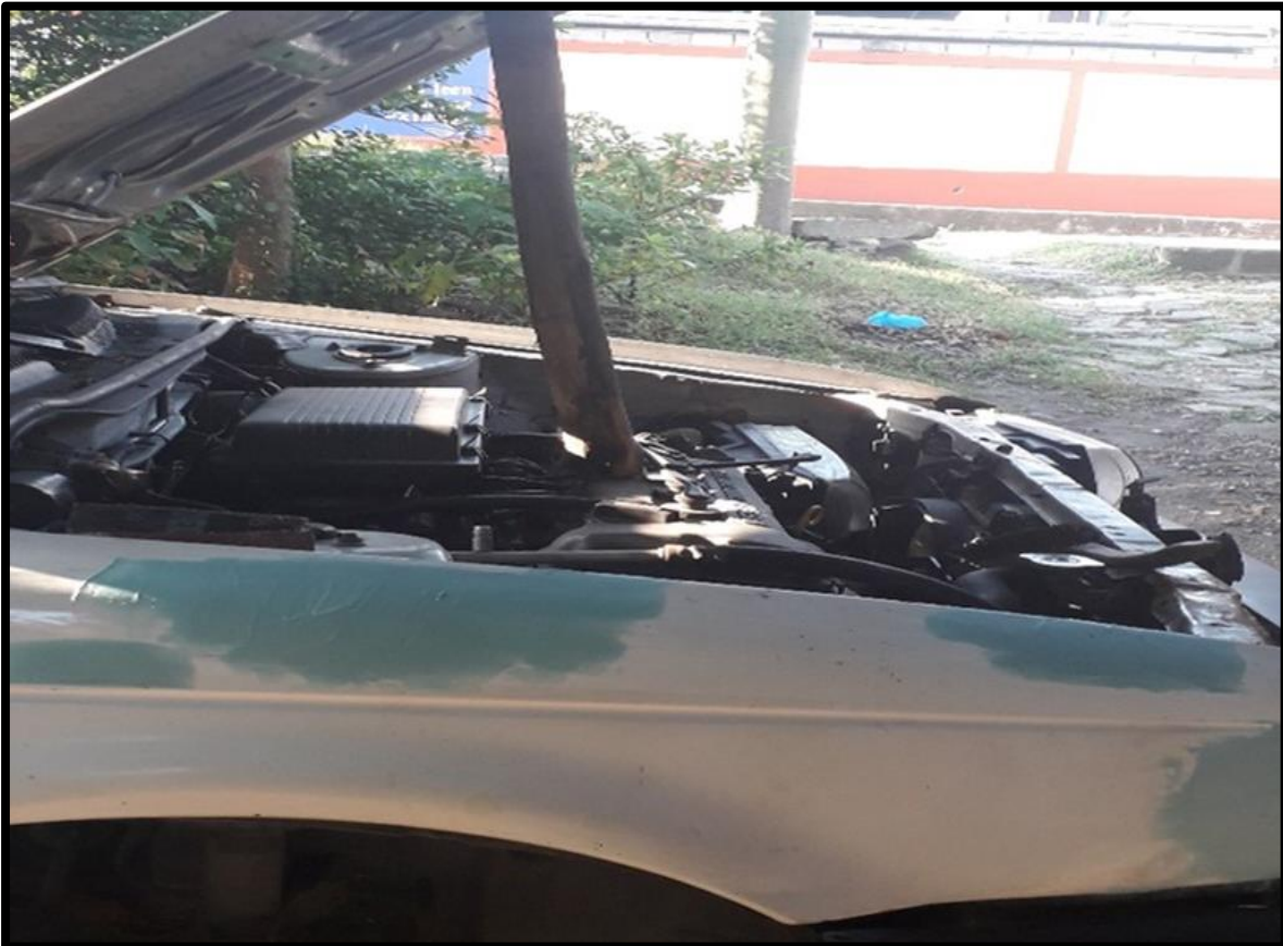
Figura 111 Sustitución de varilla de cofre Taller El Flaco
