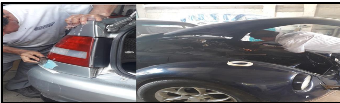
Figura 38 Lijado y soldadura
