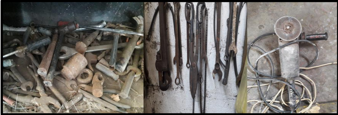
Figura 19 herramientas en malas condiciones manuales y eléctricas
