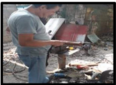
Figura 142 Soldadura autógena sin EPP Taller El Flaco Fuente: con base a la información obtenida
