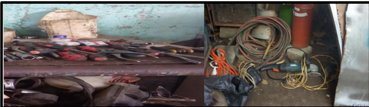
Figura 44 Herramientas en malas condiciones manuales y eléctricas
