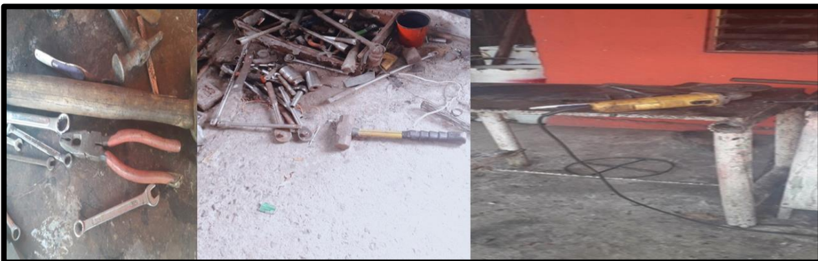
Figura 24 Herramientas en malas condiciones manuales y eléctricas
