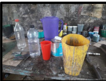
Figura 148 Almacenamiento inadecuado de productos químicos Taller El Flaco Fuente: con base a la información obtenida
