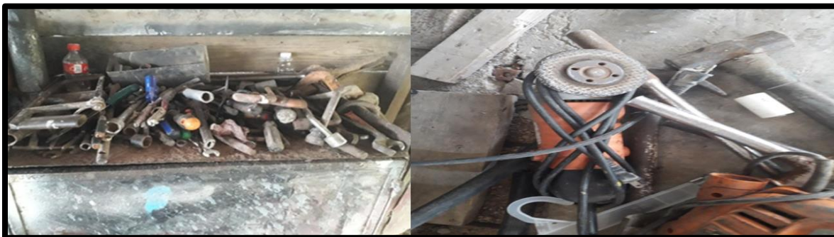
Figura 54 Herramientas en malas condiciones manuales y eléctricas
