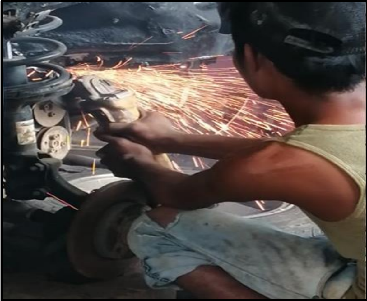
Figura 119 Falta de equipo de protección personal El Mosco
