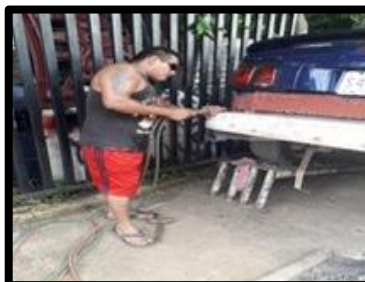
Figura 143 Soldadura autógena sin EPP Taller Mil Años Fuente: con base a la información obtenida
