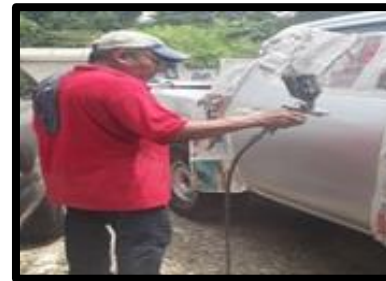
Figura 133 Aplicación de pintura sin EPP Taller Manolo Fuente: con base a la información obtenida
