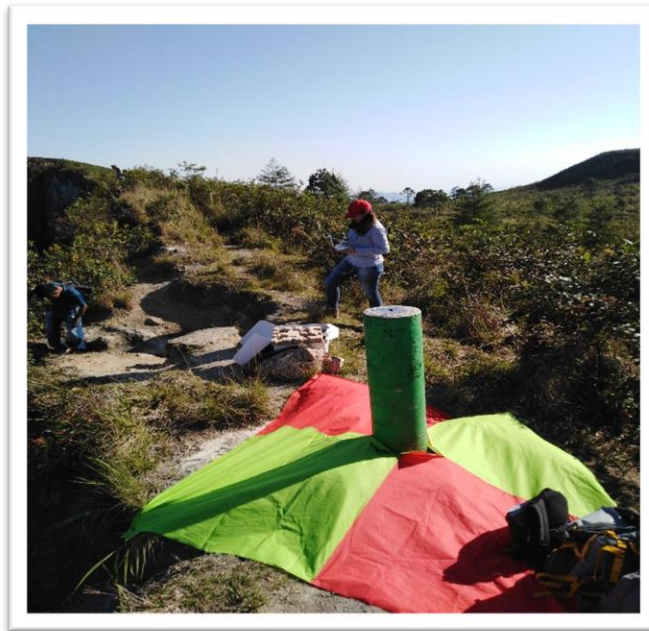
Figura 23. Diana de 2 x 2 metros para marcar los puntos de control.
