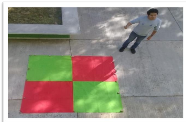
Figura 23. Diana de 2 x 2 metros para marcar los puntos de control.
