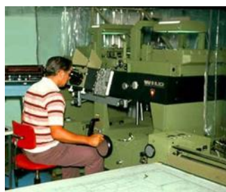
Figura 9 Restituidor analógico Wild A10 (producido 1969-1984) Cuarto instrumento universal fuente: Wild Heerbrugg (2015).
