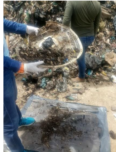
Figura 4. Cribado de residuos estabilizados.
