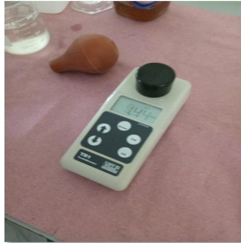
Figura 16. Determinación de turbiedad.
