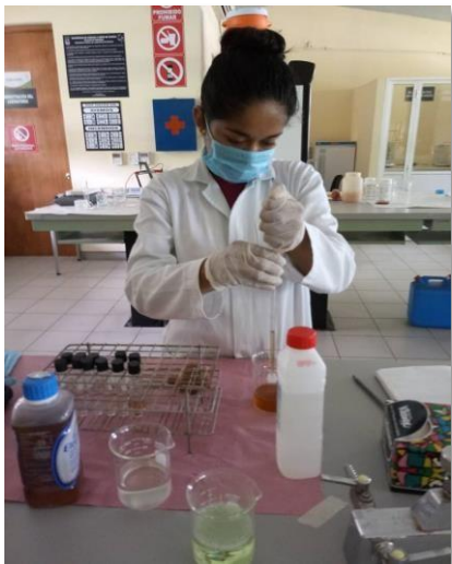
Figura 17. Determinación de color verdadero.
