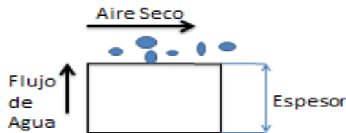
Figura 2.6 Mecanismo de difusión superficial en el transporte de vapor de agua.
