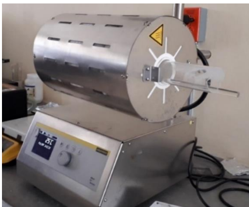
Figura 3.2. Reactor de oxidación térmica.
