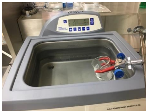
Figura 3.1. Limpieza del sustrato en baño ultrasónico.
