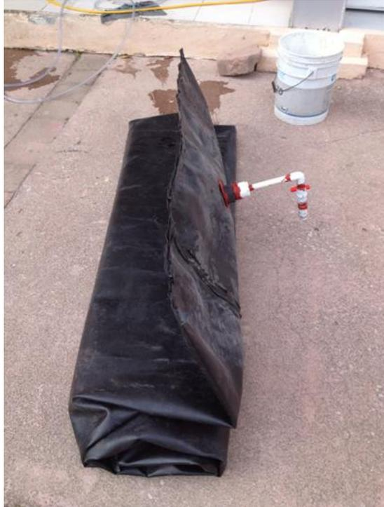
Figura 19. Bolsa de geomembrana de 3.5 m<sup>3</sup>. Fotografía, Gómez (2013).
