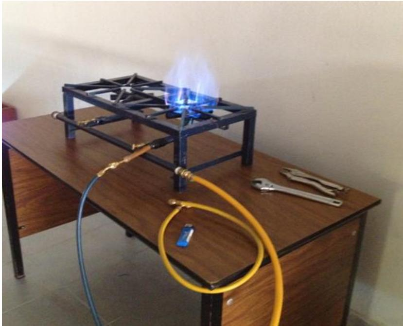
Figura 43. Flama obtenida con el Biogás purificado y comprimido. Fotografía, Gómez (2013).
