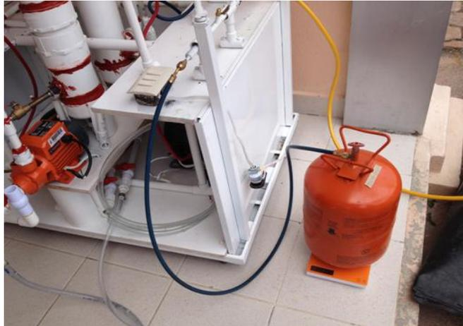
Figura 37. Mediciones de peso con el equipo en operación. Fotografía, Gómez (2013).
