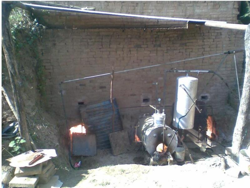
Figura 14. Equipo de aceite lubricante gastado, utilizado para cocer ladrillo. Fotografía, Gómez (2012).
