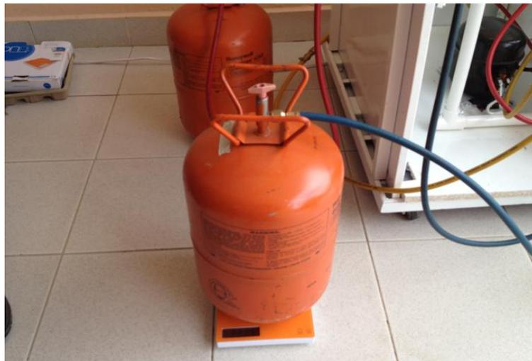
Figura 34. Báscula (medidor de masa) con el equipo en operación. Fotografía, Gómez (2013).
