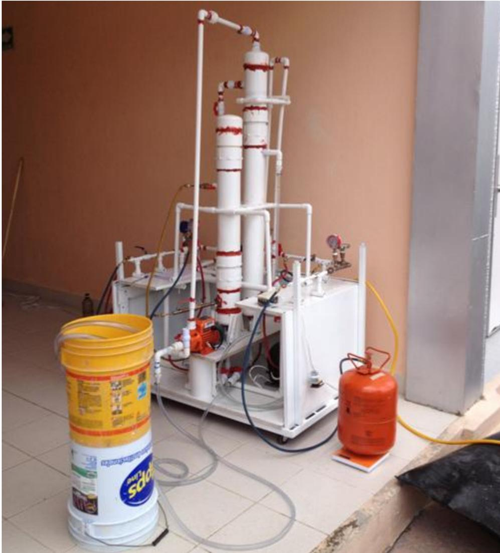
Figura 35. Sistema en funcionamiento, purificación y compresión. Fotografía, Gómez (2013).
