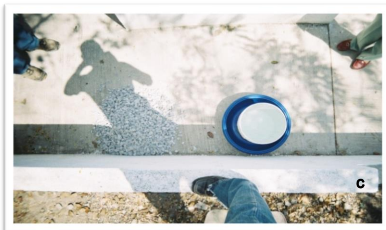
Figura 6. A) Agregación de la grava al recipiente lleno de agua. B) Grava en el recipiente lleno de agua. C) Recipientes: lleno de grava y agua (blanco) y recipiente contenedor de agua desalojada (azul).
