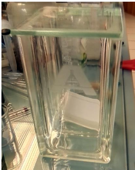
Figura 16. Cámara cromatográfica, aquí se corren muestras de la placa cromatografía con la fase móvil.
