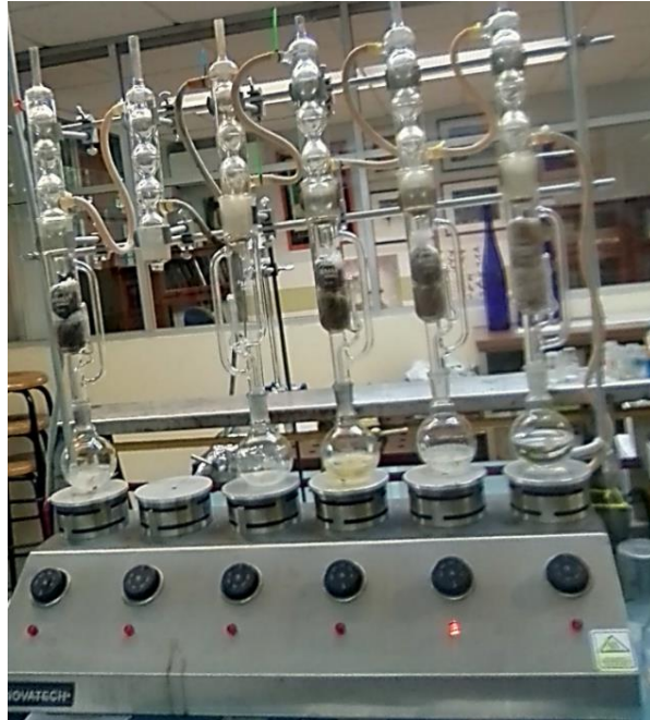
Figura 12. Equipo Soxhlet: Consta de una parrilla de calentamiento, matraz bola, un sifón o extractor por donde se coloca la muestra, y el refrigerante (donde ocurre la condensación).
