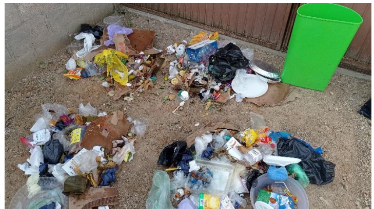
Imagen 11. Método de Cuarteo de los Residuos Sólidos obtenidos de La Colonia Corral de Piedra, San Cristóbal de Las Casas.
