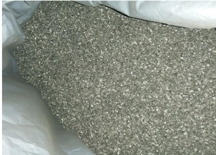
Ilustración 4. Carbón Activado Bituminoso. Fuente Propia (2021).
