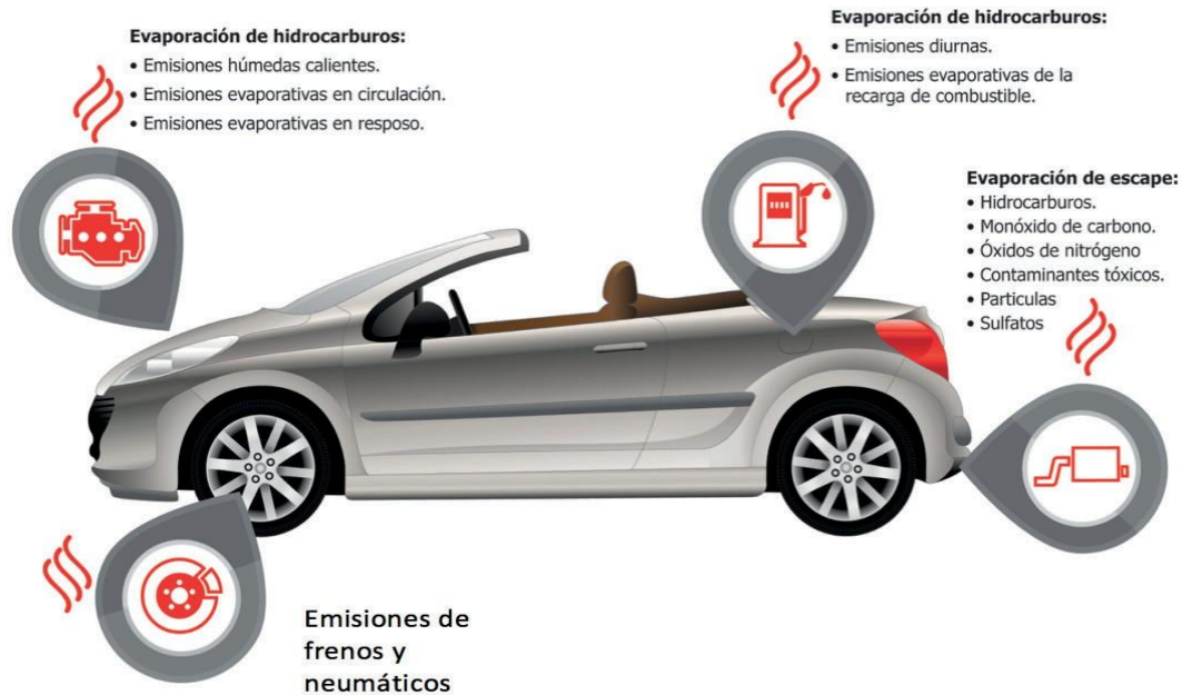
Imagen 2.2 Proceso de emisión en vehículos automotores
