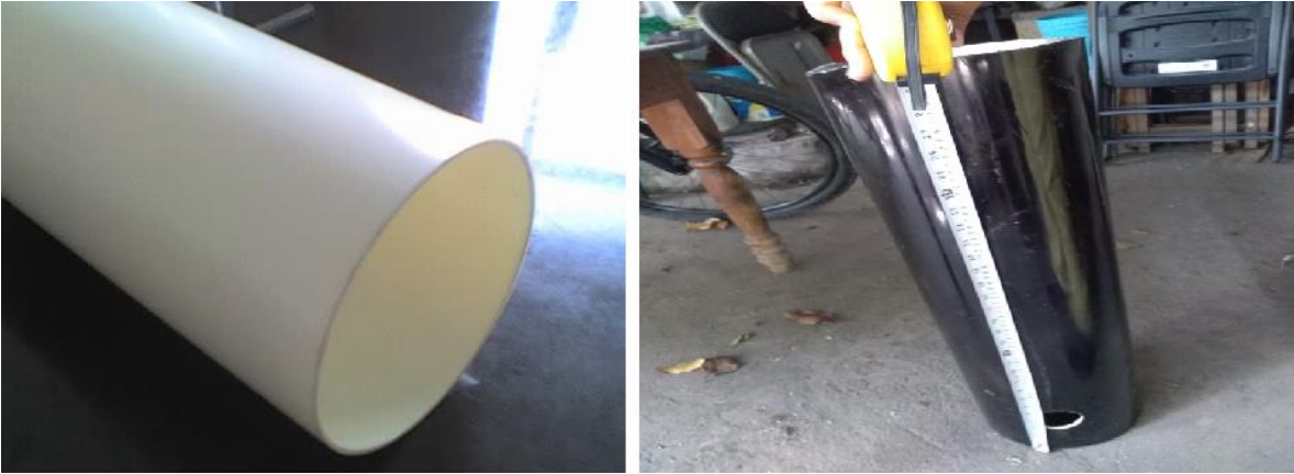
Ilustración 5- Al no contar con un medio para montar el lavabo y teniendo en cuenta el gasto económico, se buscó algo que pudiera ser reutilizado, teniendo como la mejor opción el tubo de PVC, ya que puede cargar el lavabo siendo de fácil manipulación y pegado.
