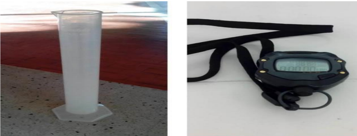
Ilustración 6- Uso de la probeta y el cronómetro para medir caudales mediante el método volumétrico utilizado por (Montaño,2015).
