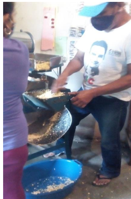
Fotografía 21. Transformación del nixtamal a masa en el molino.
