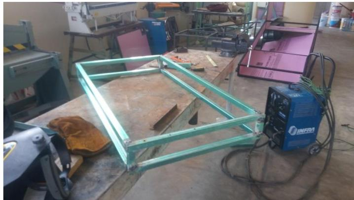
Figura 4.4. Estructura del colector solar (A. Matus, 2019).
