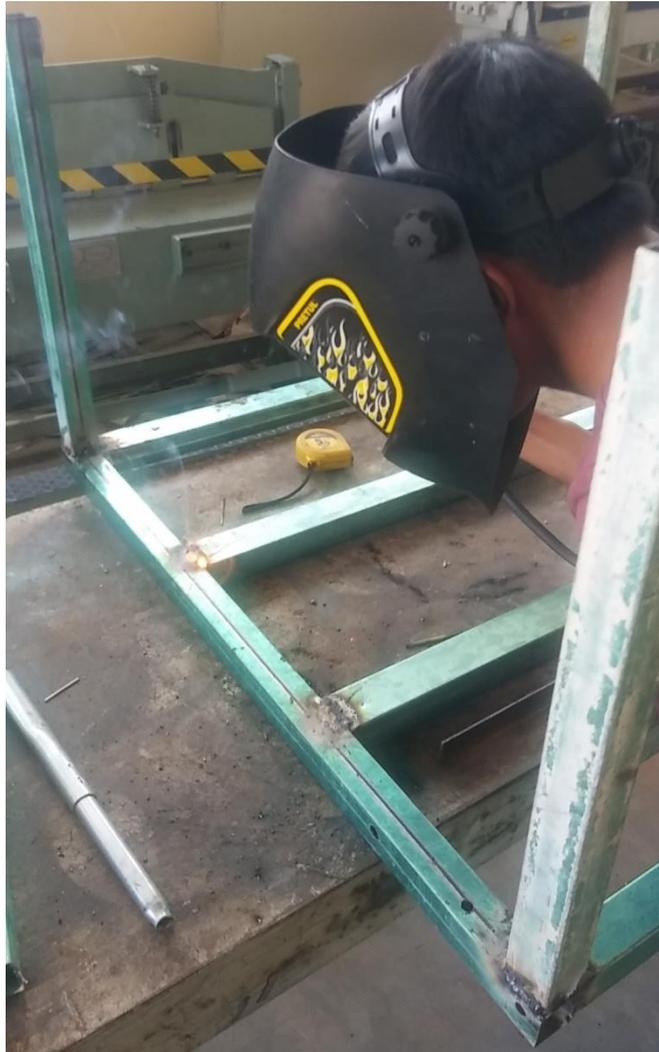
La altura de dicha base será de 0.50 m, para ello se necesitan tramos de perfil rectangular de 1.5" los cuales serán soldados como se muestra en la figura anterior.
