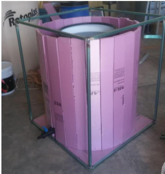
Paso 14. Construir una base que dará soporte tanto al tanque de almacenamiento como a la caja colectora. Para esto se necesitan 6 tramos de perfiles rectangulares de 1.5" a un largo de 0.95 m, los cuales serán soldados de tal forma de que la base sea un cuadrado con 2 soportes paralelos en el interior, como se muestra en la figura.
