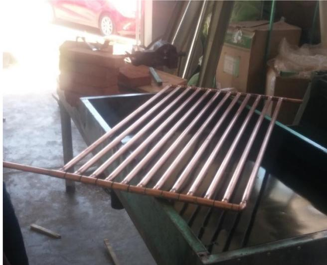
Paso 6. Una vez armada y soldada la parrilla de tubos se procede a comprobar la existencia de fugas. Esto puede lograrse suministrando un flujo de agua por alguna de las entradas y obstruyendo la de lado contrario. En caso de fugas se procede a soldar nuevamente la parte donde ésta se presente.
