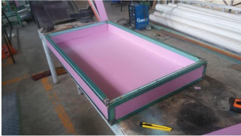
Paso 3. Recortar la lámina galvanizada a las dimensiones de las caras de la caja anteriormente construida y recubrirla con ayuda de remaches.
