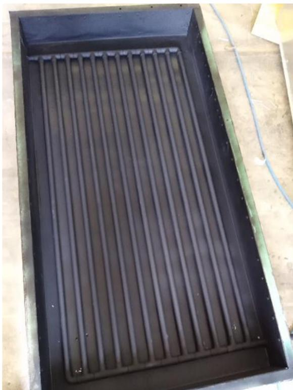
Paso 9. Fijar los tubos de la parrilla a la placa absorbente de la caja, esto se logra con abrazaderas de 1/2" y con la ayuda de remaches. Se utiliza la cantidad de abrazaderas que sean necesarias para que la parrilla quede lo más adherida posible a la placa absorbente.
