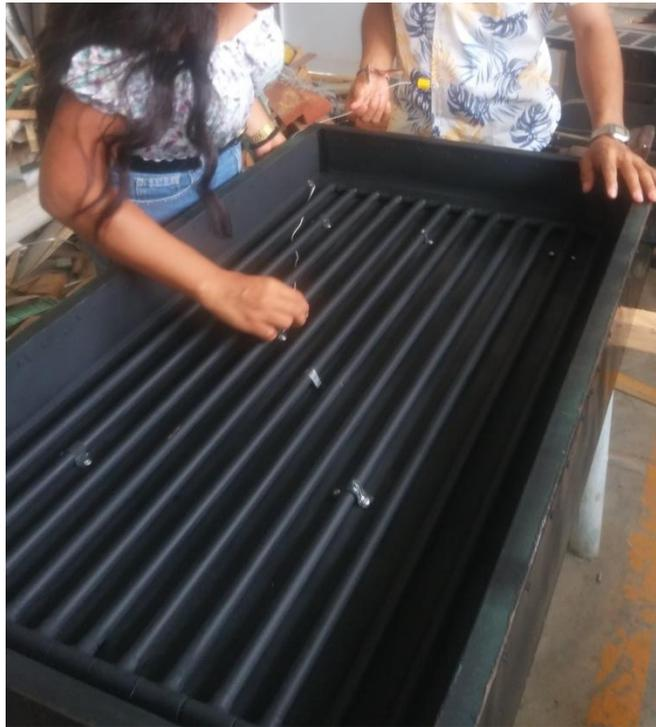
Figura 4.6. Sistema de tubería del colector solar (A. Galicia, 2019).
