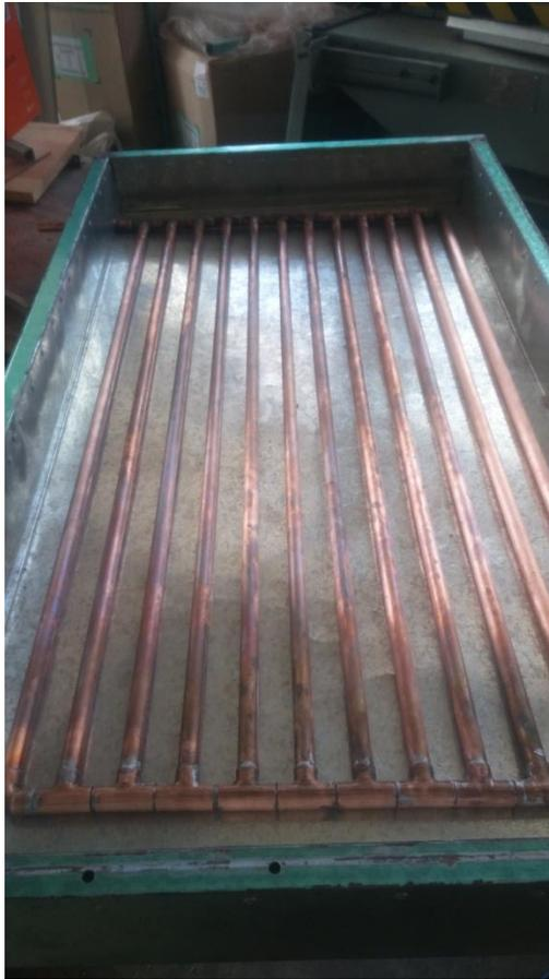
Paso 8. Una vez realizadas las perforaciones se procede a pintar tanto la caja colectora como la parrilla de tubos. La pintura utilizada puede ser en aerosol y deberá ser de color negro mate. Posterior a esto se coloca la parrilla en la caja colectora de tal forma que esta quede centrada.
