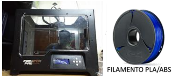
Figura 18. Impresora y filamento para la impresión de la carcasa.
