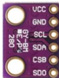
Figura 7. Módulo BME280 con sensor de temperatura, humedad y presión atmosférica (Herrero, 2019).
