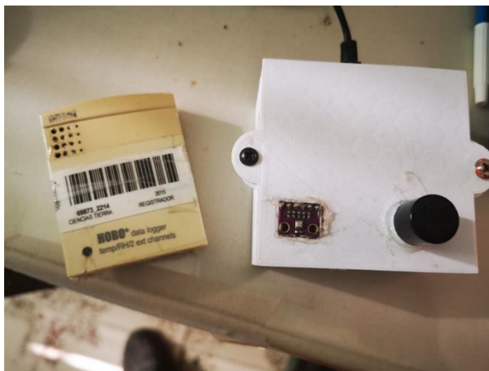
Figura 11. Prueba de funcionamiento del HOBO (izquierda) vs REMOTH (derecha).
