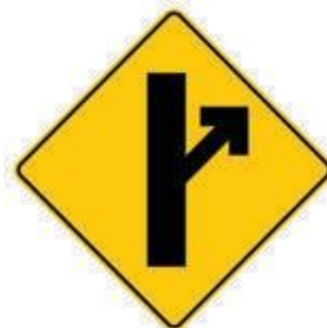
Figura No. 18: Señal de salida próxima Fuente: Manual de Señalización vial y dispositivos de seguridad
