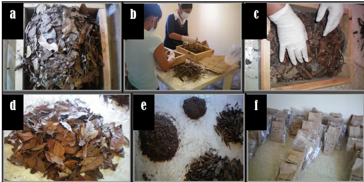
Figura 21. Separación de los combustibles, a) muestra tal y como es tomada en el sitio, b,c) eliminación de las impurezas, d) combustible separado e) Materiales, suelo mineral y capa de fermentación, ramas y ramillas f) combustible fino listo para ser secado.
