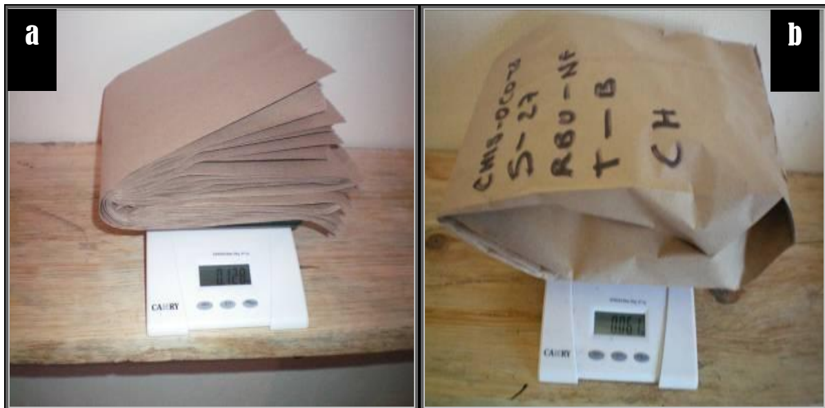
Figura 22. a) Calculando el promedio del peso de las bolsas; b) determinando el peso inicial del combustible (hojarasca).
