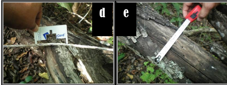
Figura 18. Medición de combustibles de: a) 1Hora (0 a 0.6 Cm), b) 10 Horas (0.61 a 2.5 Cm), c) 100 Horas (2.51 a 7.6 Cm); d, e) 1000 Horas, utilizando calibrador y flexómetro (> 7.6 Cm).
