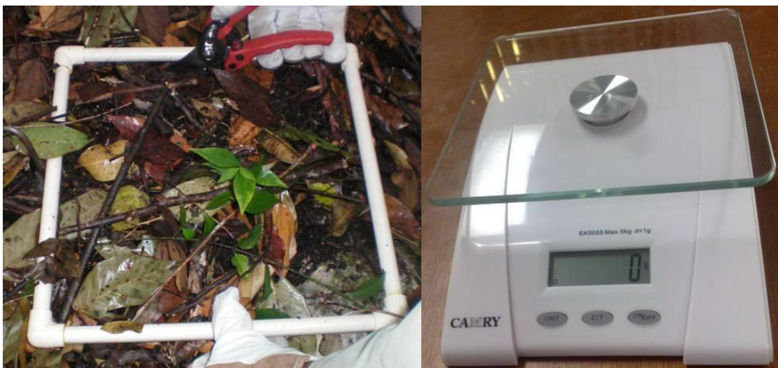
Figura 8. Muestreo de combustible ligero, en un cuadro de 30 por 30 cm, y báscula de precisión para el pesado de combustible.
