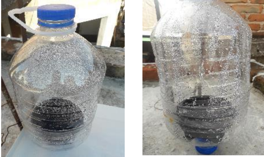
Imagen 3. Destilador casero donde se observa la condensación del lixiviado.
