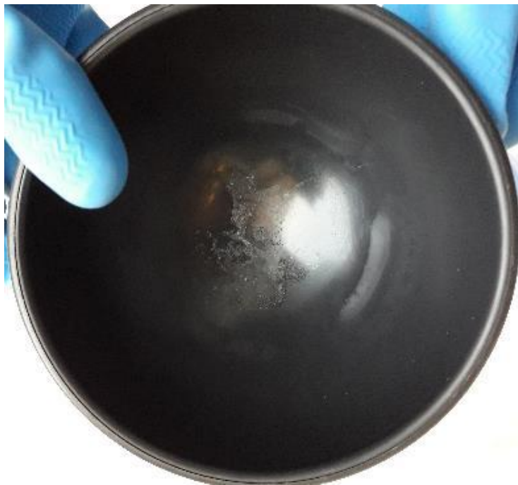
Residuos de lixiviado tras segunda etapa de destilación
