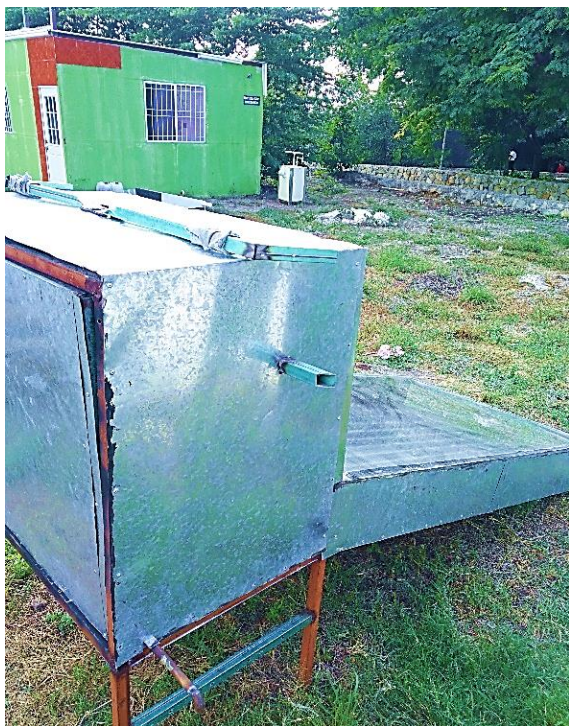
Figura 17. Secador solar indirecto (tipo armario) (visto de un costado).
