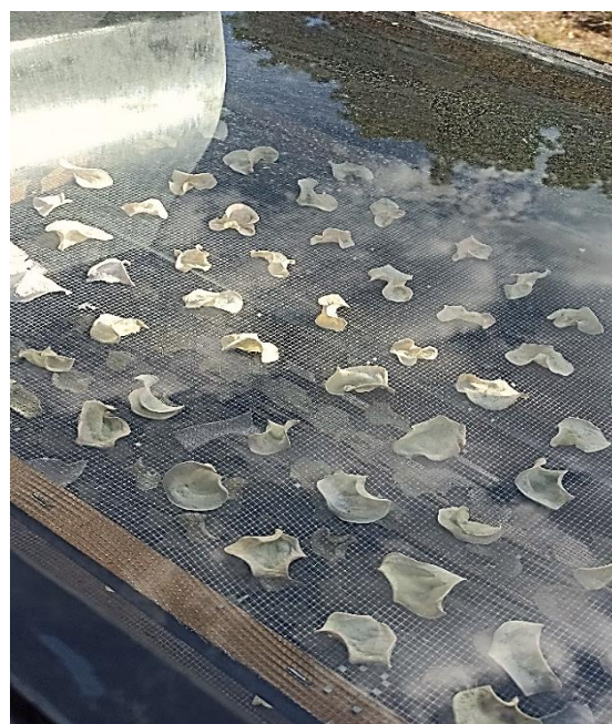
Figura 59. Proceso de deshidratado del producto en secador solar directo.
