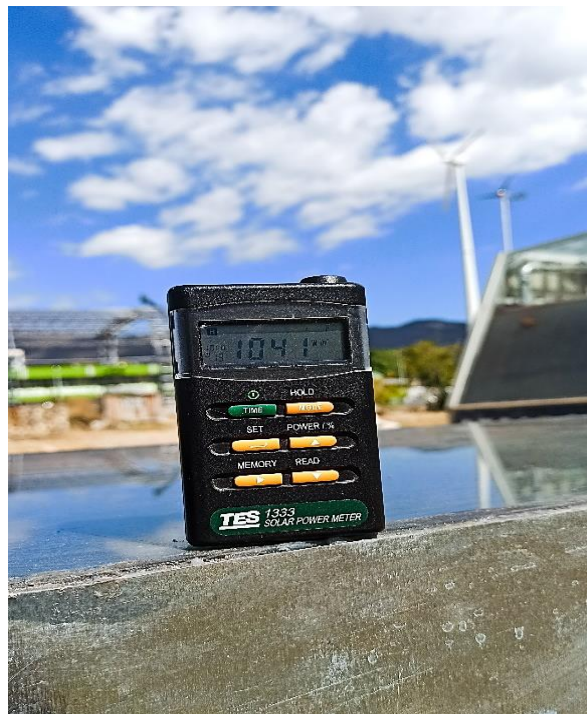
Figura 57. Medición de la radiación solar con el solarímetro.
