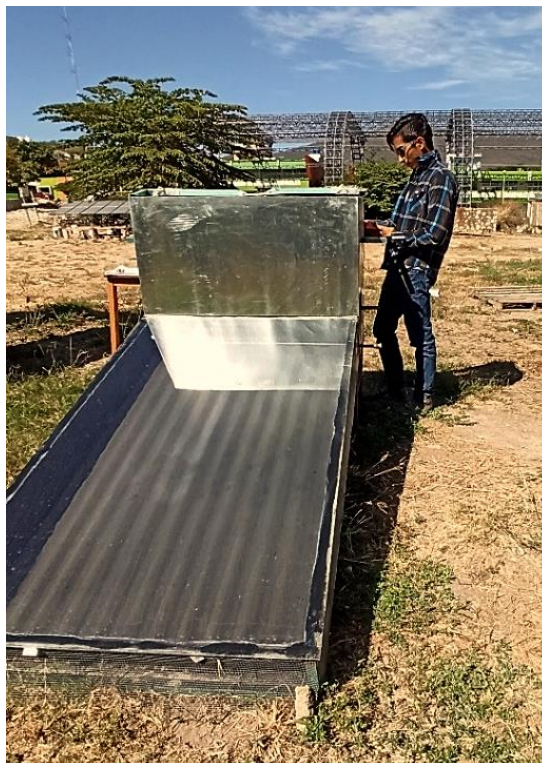
Figura 35. Medición de temperatura en la cámara de secado.
