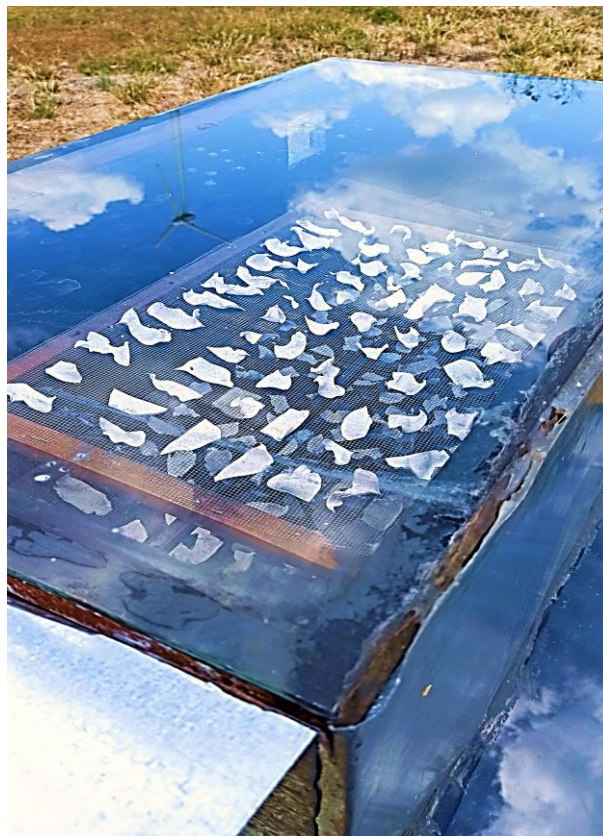
Figura 20. Secador solar directo (tipo armario) (visto de arriba).
