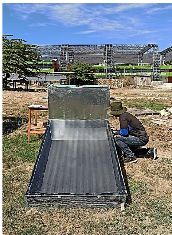
Figura 42. Medición de temperatura en la cámara de secado.
