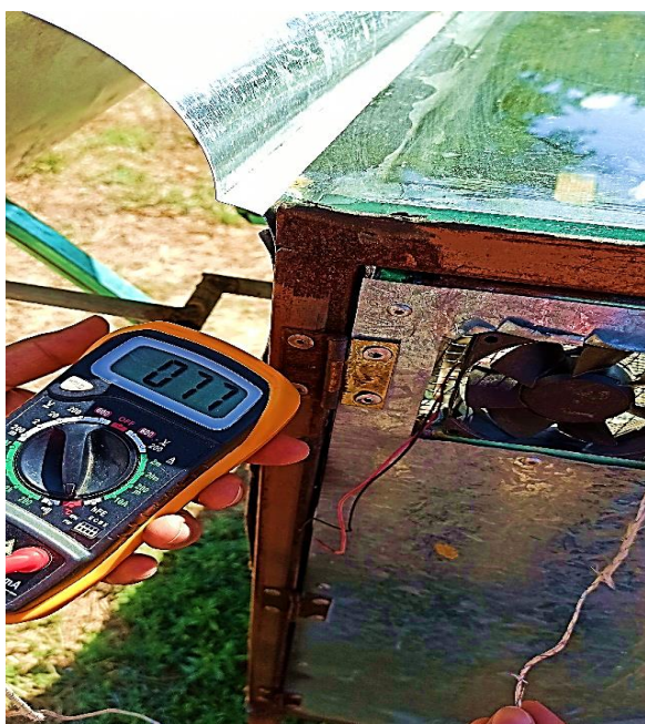
Figura 58. Medición de temperatura en la cámara de secado en secador solar directo.
