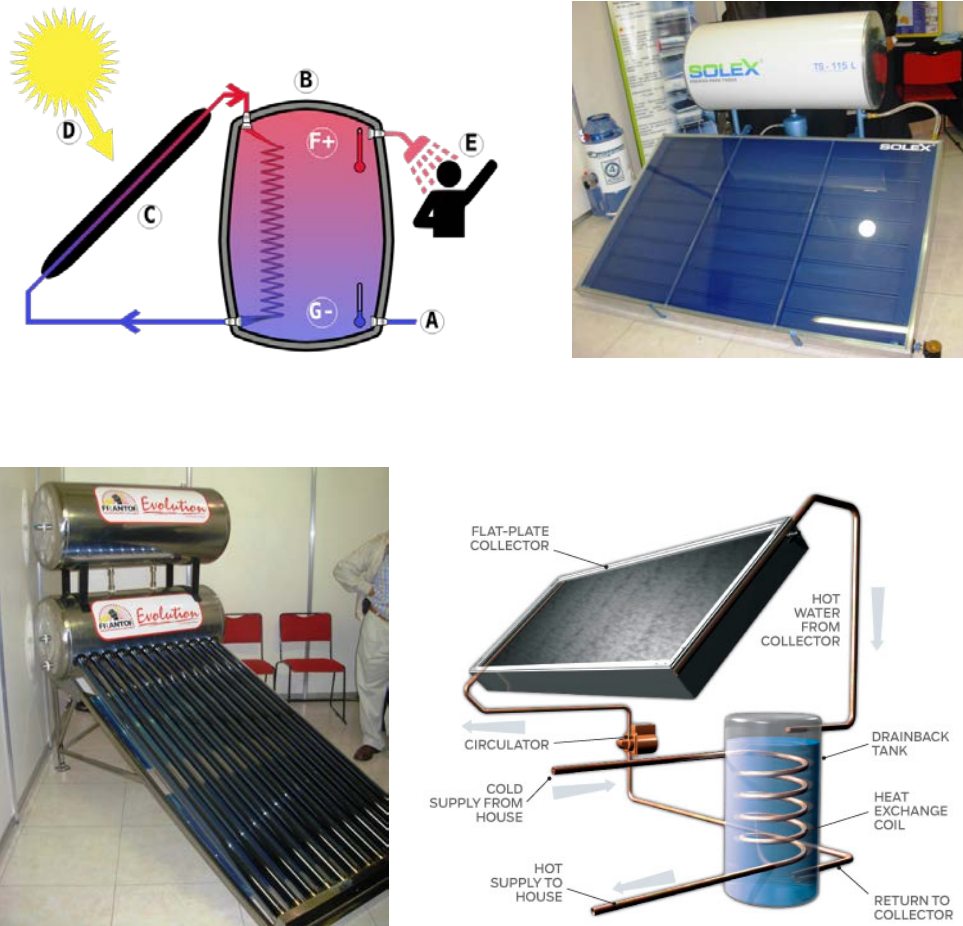
Figura 1.5.6. Calentadores de Agua Solares. Arriba izquierda: Esquema de calentador solar plano típico. Arriba derecha: Calentador solar plano termosifónico con sistema auxiliar eléctrico. En medio izquierda: Calentador de agua con colector evacuado de doble termotanque. En medio derecha: Esquema de calentador solar plano de agua con circulación forzada. Fotografías: N. Farrera
