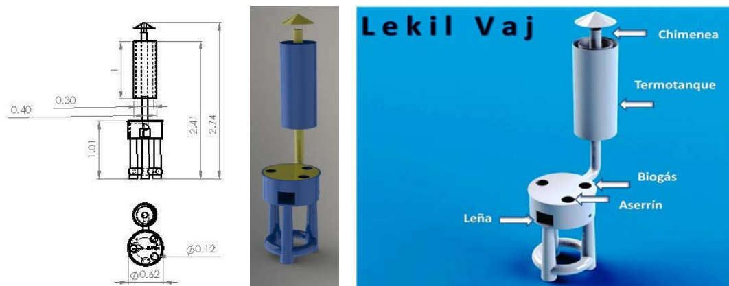
Figura 3.1.13. Modelo de la primera versión de la estufa Lekil Vaj.
