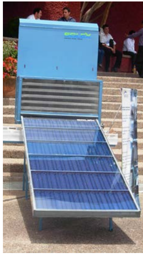
Figura 1.5.3. Secador Solar típico de tipo Indirecto por Convección Natural. Foto: N. Farrera
