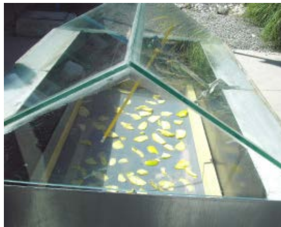
Figura 1.5.5. Deshidratador Solar Pasivo de tipo Directo. Fotografía: L. M. Torres. Revista Solar
