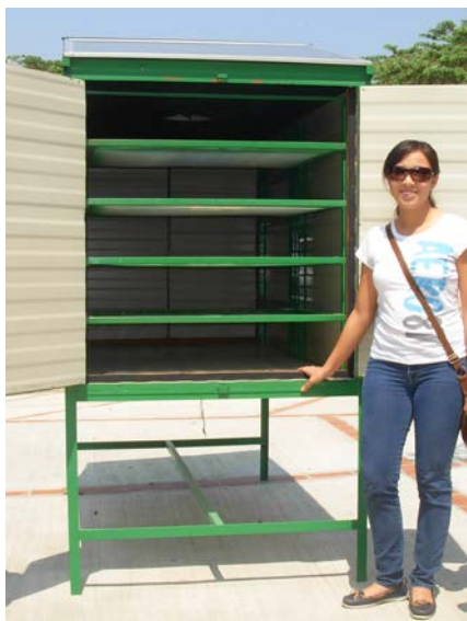
Figura 3.1.16. Secador Solar Multipropósito hecho con materiales térmicos prefabricados. Foto: N.
