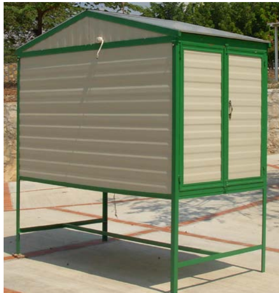
Figura 4.2.1. Secador Multipropósito hecho con módulos prefabricados. Foto: N. Farrera
