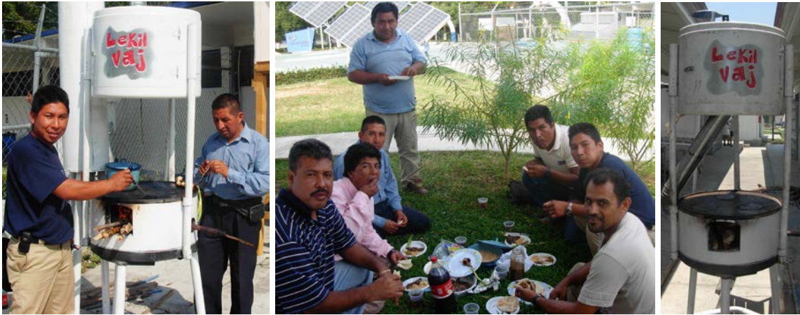
Figura 4.1.3. Pruebas de funcionamiento con miembros de la comunidad y prototipo final de la Estufa Multifuncional Ahorradora Lekil Vaj. Foto: N. Farrera
