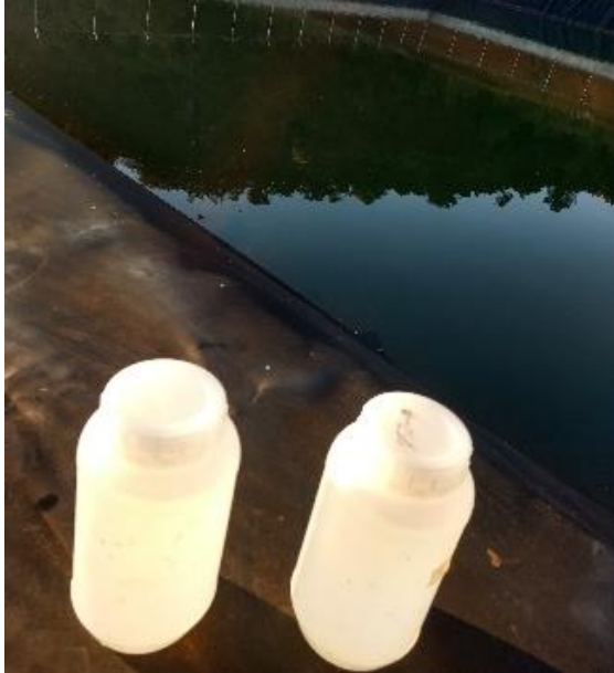
Figura 10. Recipientes de doble tapa para la toma de muestras para análisis físico-químicos
