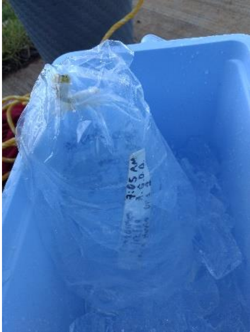
Figura 13. Muestra para coliformes fecales y coliformes totales.
