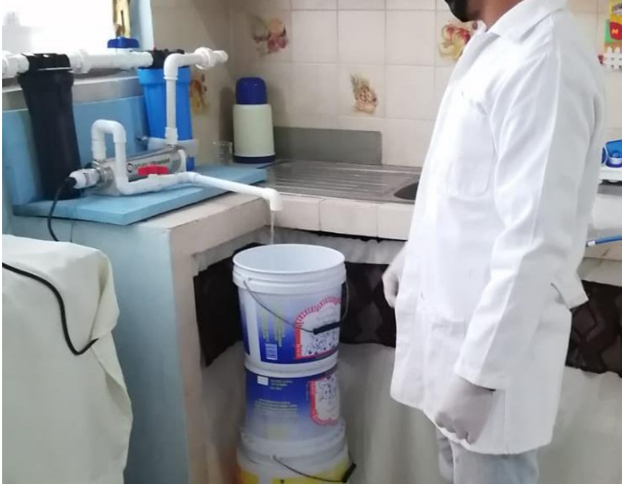
Figura 14. Agua pasando por el filtro UV para remover contaminantes, principalmente del tipo microbiológico
