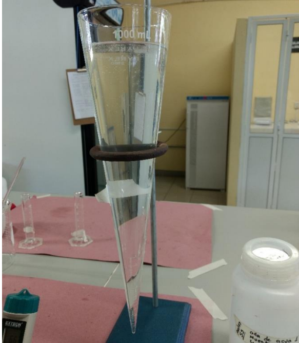
Figura 11. Prueba de Sólidos Sedimentables
