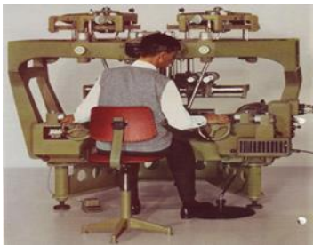
Figura 7 Restituidor analítico Wild A7 (producido en 1952-1972) fuente: Wild Heerbrugg (2015).
