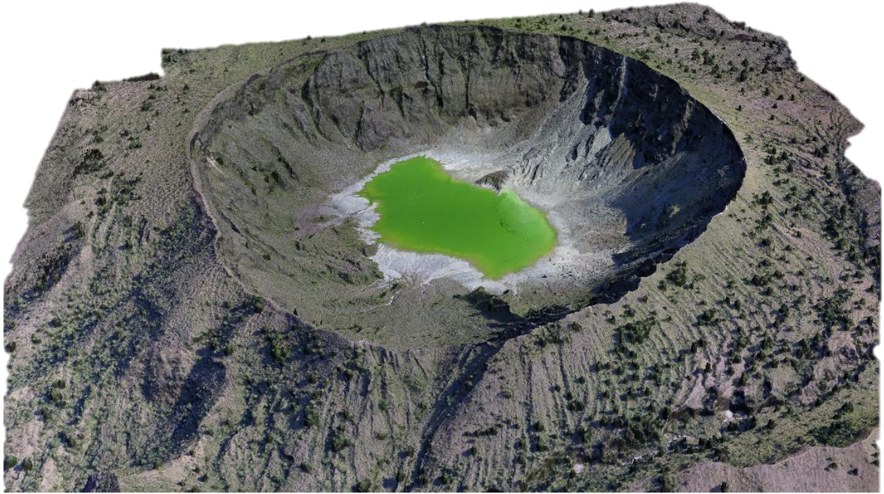
Figura 34. Modelo 3D generado con Agisoft Photoscan
