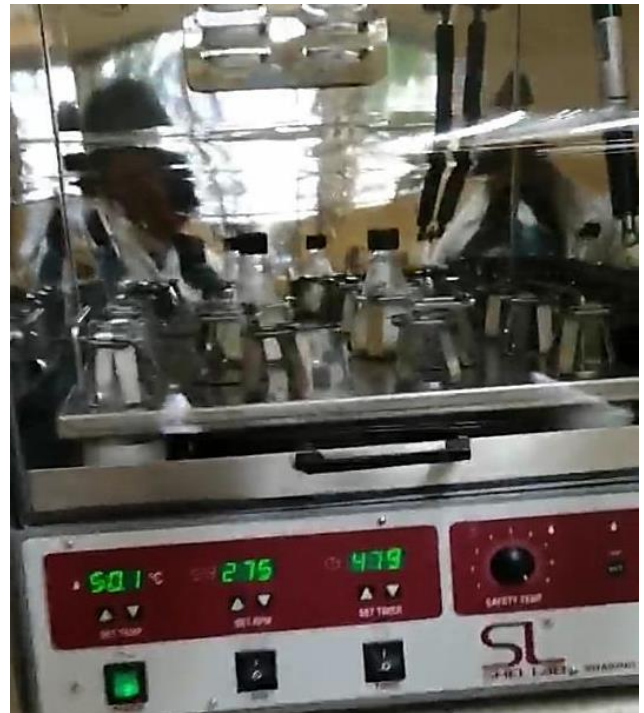
Figura 28. Matraces dentro de la incubadora con agitación
