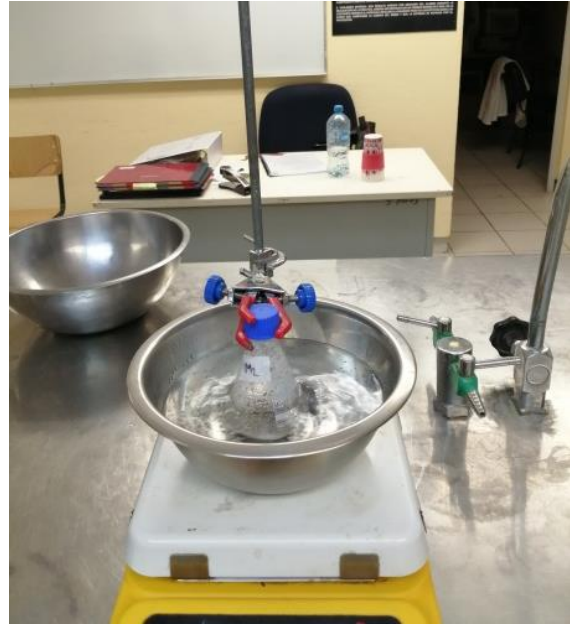
Figura 25. Calentamiento de la muestra a 100°C
