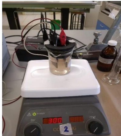
Figura 3.- Montaje de la prueba de oxidación avanzada.
