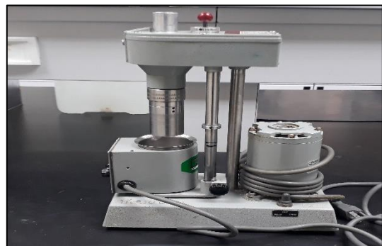
Figura No. 51 Realización de marcas en pata de apoyo de viscosímetro
