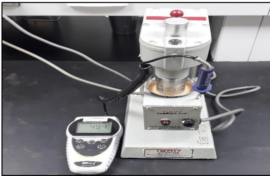
Figura No. 52 Prueba de Sag Shoe a 49°C.
