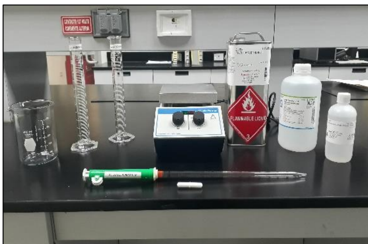
Figura No. 83 Materiales y reactivos para realizar prueba de alcalinidad de fluido base aceite de emulsión inversa.
