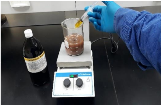
Figura No. 87 Adición de 3 ml de solución indicadora cromato de potasio al 5%.
