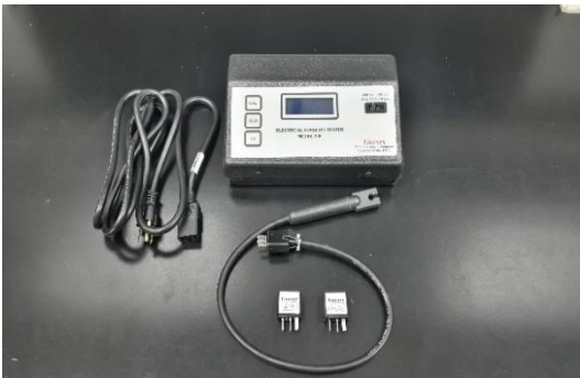
Figura No. 18 Medidor de estabilidad eléctrica, cable de corriente, electrodo y chips de calibración.
