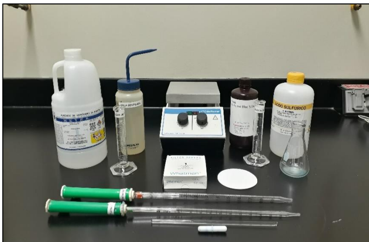
Figura No. 77 Materiales y reactivos para prueba de azul de metileno.
