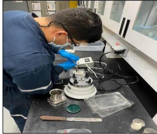
Figura No. 57 Adición de 5ml de la mezcla de salmuera y formación en el tubo filtro.
