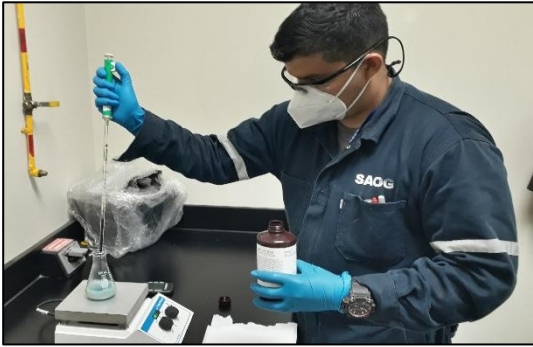
Figura No. 78 Adición de 0.5 ml de azul de metileno.
