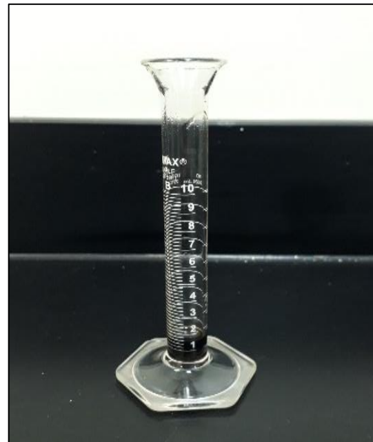
Figura No. 35 Muestra de filtrado al finalizar la prueba después de 30 minutos.
