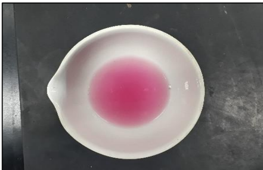
Figura No. 66 Fluido base agua con solución indicadora fenolftaleína.
