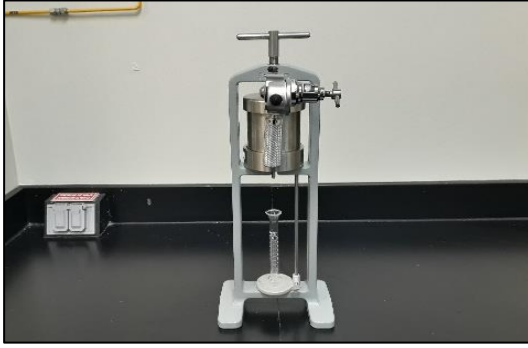
Figura No. 30 Prueba de filtrado en filtro prensa individual presurizado con capsulas de CO 2 .
