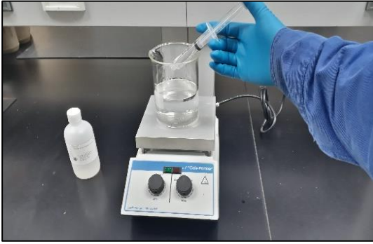
Figura No. 81 Adición de 15 gotas de solución indicadora fenolftaleína al 1% a mezcla de propoxypropanol con agua destilada.
