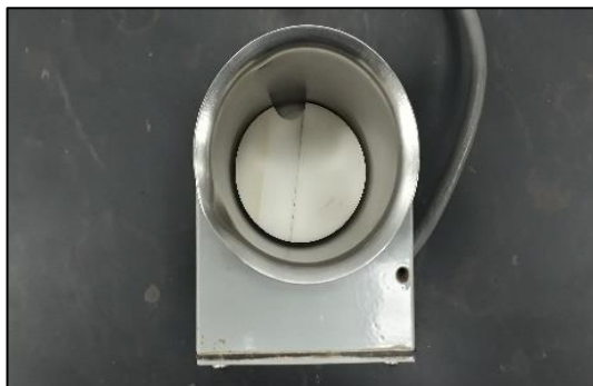
Figura No. 50 Zapato de hundimiento colocado en la termocopa.
