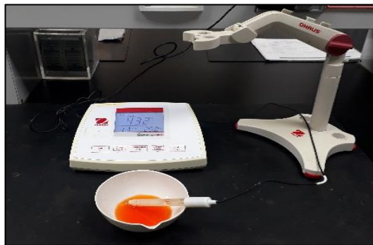
Figura No. 65 Punto final de prueba de alcalinidad de naranja de metilo (mf).
