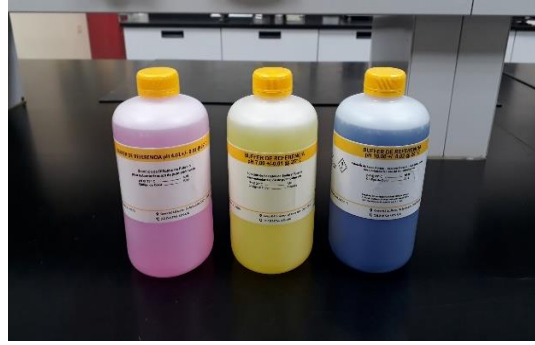
Figura No. 59 Soluciones buffer para calibrar pHmetro.
