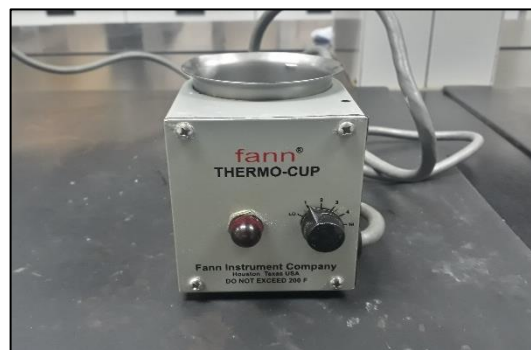
Figura No. 15 Termocopa con termostato controlado.
