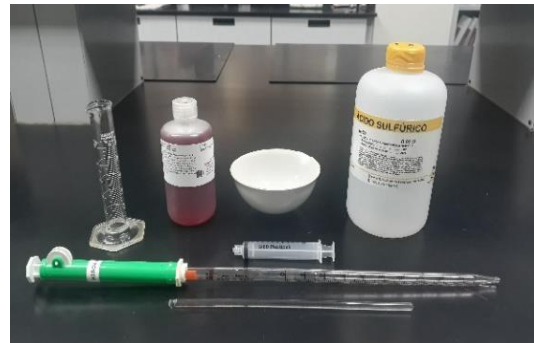
Figura No. 63 Materiales y reactivos para realizar prueba de alcalinidad del filtrado con solución naranja de metilo.
