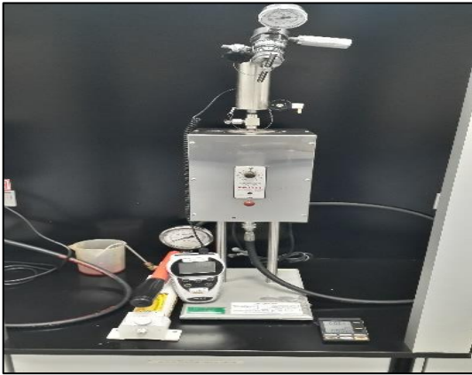
Figura No. 42 Realización de prueba PPT con recolector tradicional para material de poco micronaje.
