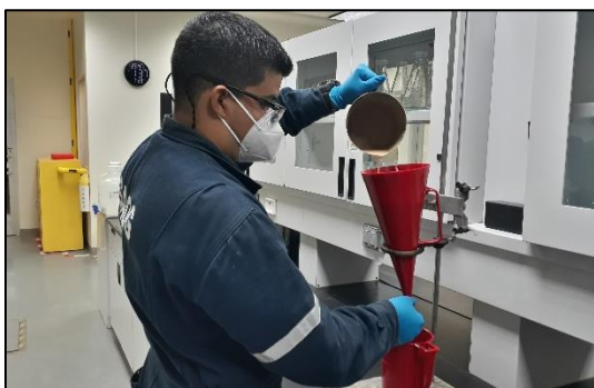
Figura No. 12 Adición de 1Lt de lodo en embudo Marsh.
