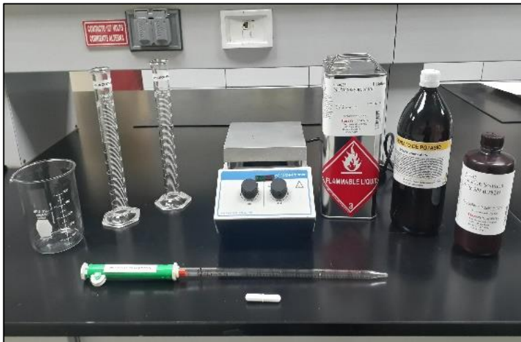
Figura No. 86 Materiales y reactivos para realizar prueba de cloruros de fluido base aceite de emulsión inversa.
