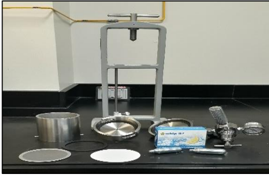
Figura No. 28 Kit completo para filtrado API con filtro prensa individual y capsulas de CO 2 .
