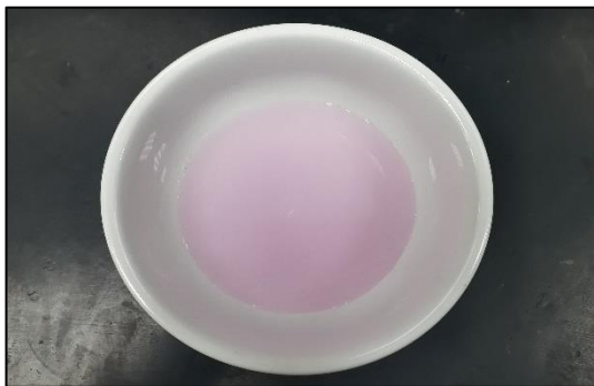
Figura No. 64 Muestra de filtrado con solución indicadora fenolftaleína (pf).
