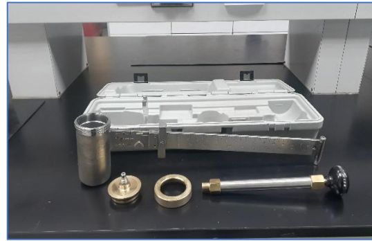
Figura No. 6 Balanza presurizada, tapa con válvula de retención, émbolo de presurización.
