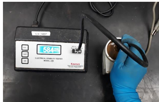
Figura No. 23 Realización de prueba de estabilidad eléctrica.
