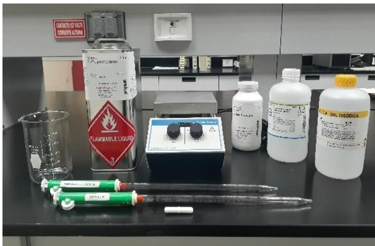
Figura No.89 Materiales y reactivos para realizar prueba de concentración de calcio de fluido base aceite de emulsión inversa.
