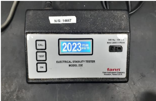
Figura No. 20 Aumento de voltaje hasta 2023 voltios.
