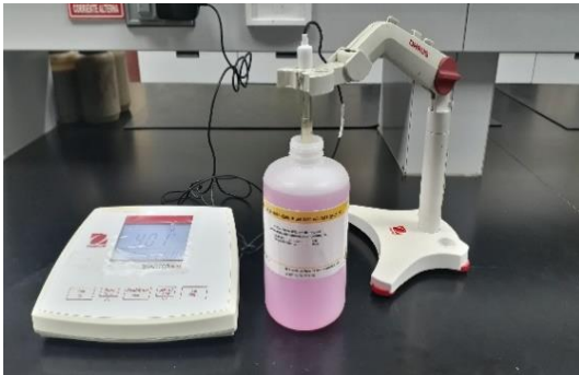
Figura No. 60 Calibración del equipo con solución acida buffer pH 4.
