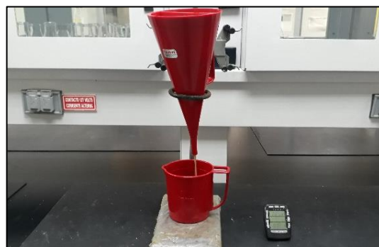
Figura No. 13 Realización de prueba viscosidad Marsh
