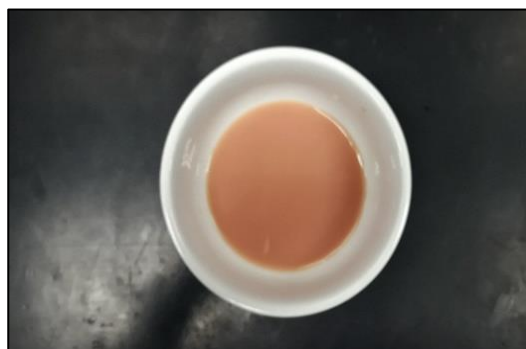
Figura No. 70 Punto final de prueba de iones cloruros.
