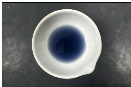
Figura No. 76 Punto final de prueba dureza total (magnesio).
