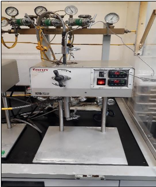
Figura No. 34 Prueba de filtrado HPHT a 150°C.
