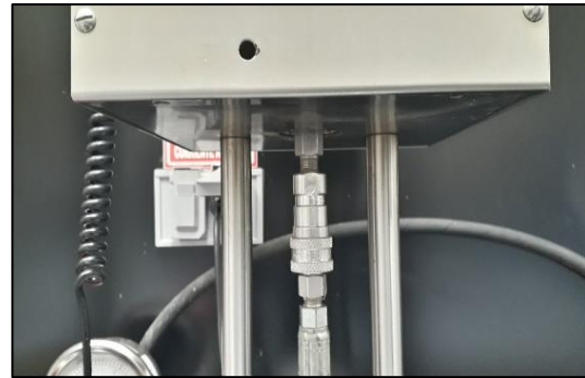
Figura No. 39 Celda conectada a la bomba hidráulica (unidad de presión).
