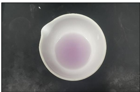
Figura No. 75 Muestra de filtrado con solución indicadora de dureza versenato.
