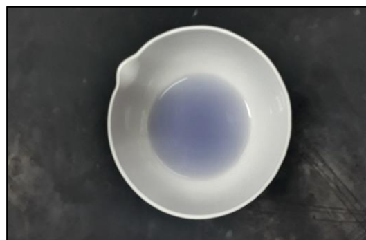
Figura No. 73 Punto final de prueba dureza de calcio.
