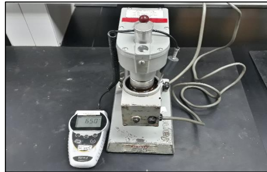
Figura No. 17 Prueba de Reología a fluido de emulsión inversa a 65°C.
