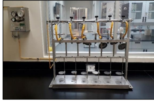
Figura No. 29 Tren de gas para filtrado API con nitrógeno.
