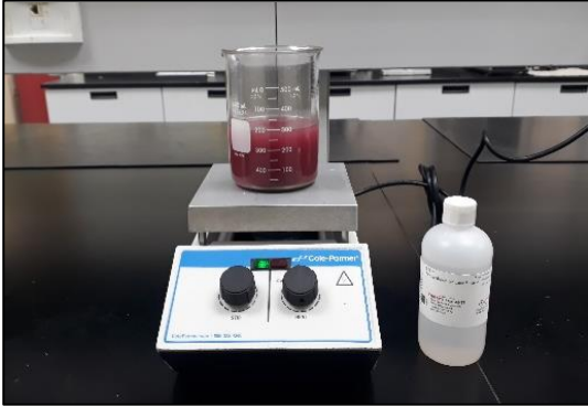
Figura No. 84 Muestra con solución indicadora fenolftaleína al 1%.
