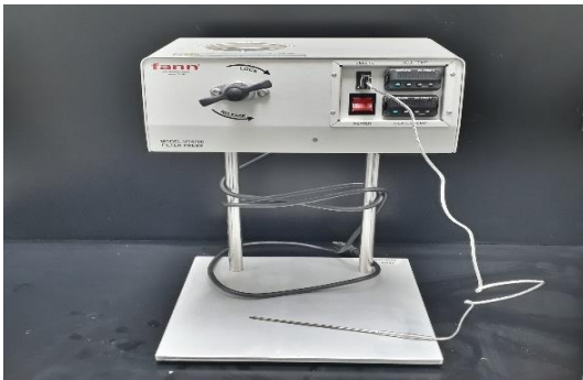
Figura No. 32 Camisa de calentamiento con termómetro para prueba de filtrado HPHT.
