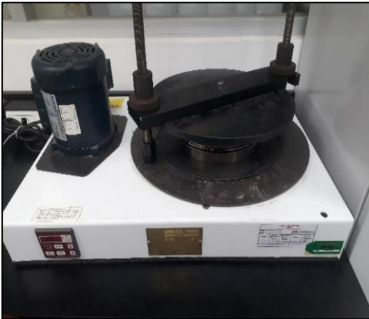
Figura No. 56 Tamizado de la formación pasada por malla 100 en el Ro-tap.
