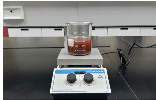
Figura No. 88 Punto final de la prueba de cloruros de fluido base aceite de emulsión inversa.
