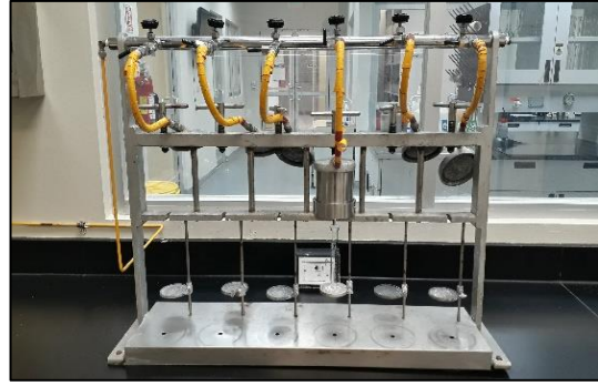
Figura No. 31 Filtrado en tres de gas presurizado con nitrógeno.
