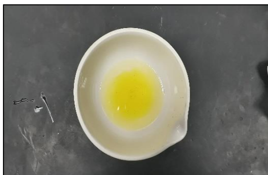
Figura No. 69 Muestra de filtrado con solución indicadora cromato de potasio.
