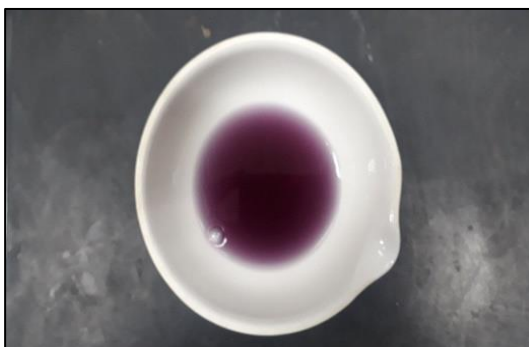
Figura No. 72 Muestra de filtrado con solución indicadora de calcio calver II.
