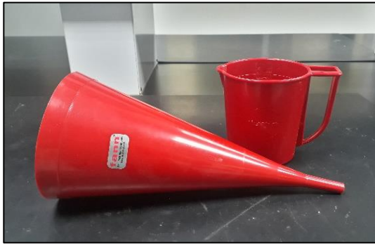
Figura No. 9 Embudo y vaso graduado (pocillo) Marsh con capacidad de 1lt.
