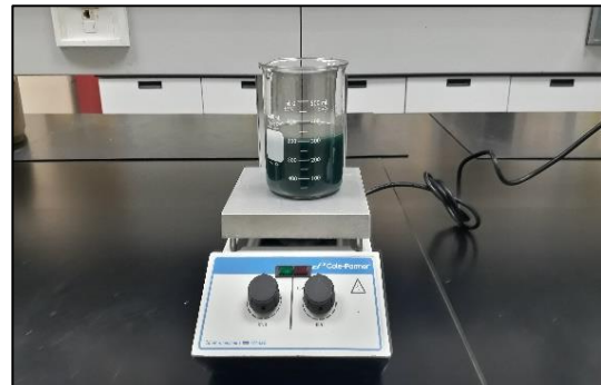
Figura No. 91 Punto final de la prueba de concentración de calcio de fluido base aceite de emulsión inversa.
