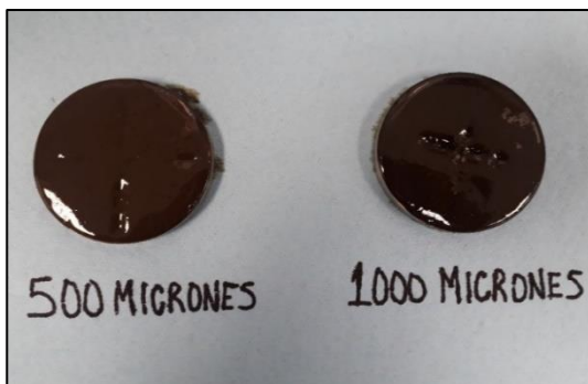
Figura No. 44 Discos metálicos de 500 y 1000 micrones con revoque al finalizar la prueba de PPT.
