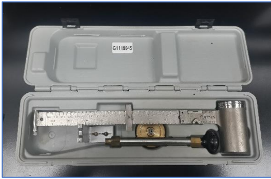
Figura No. 5 Balanza presurizada en su caja.
