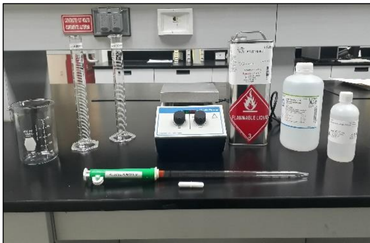
Figura No. 80 Materiales y reactivos para realizar prueba de alcalinidad de la base propoxypropanol.
