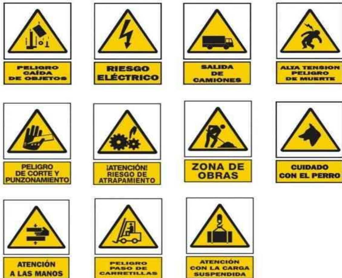
Figura 5: Señales de Peligro o Advertencia, Fuente (Google scholar)
