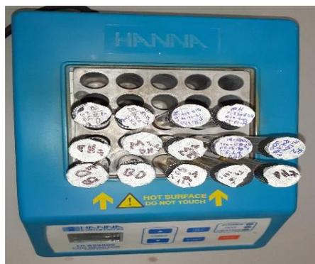
Figura 6 Tubos de DQO en digestor HANNA HI 839800
