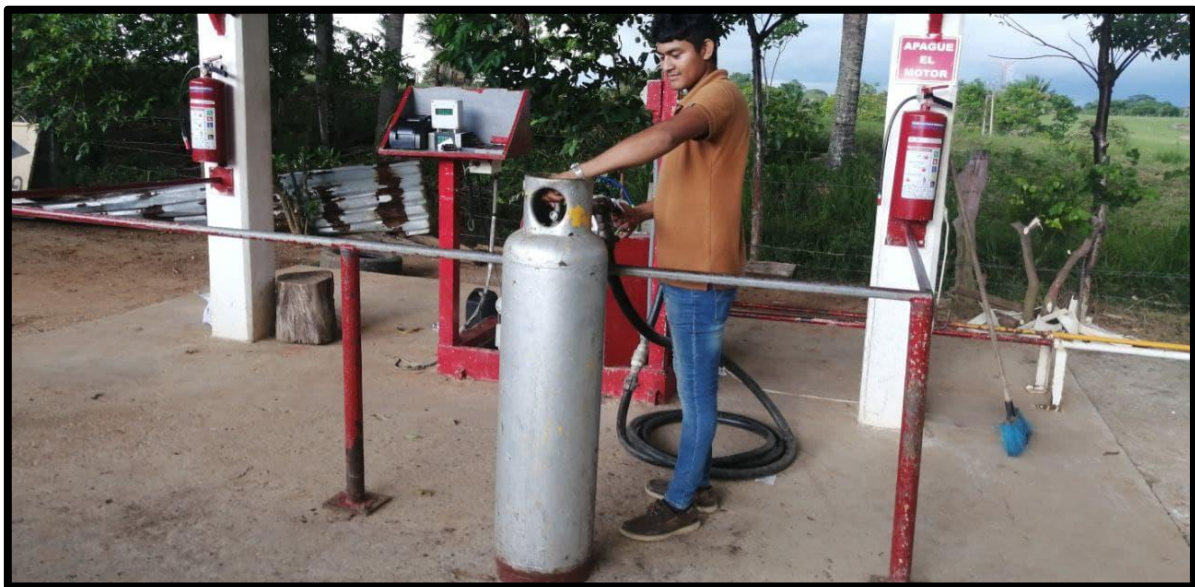
Figura 18 Terminado del llenado así mismo cierra la válvula del tanque
