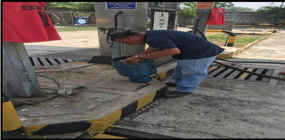
Figura 25 El trabajador revisa si el tanque está en buenas condiciones para el llenado
