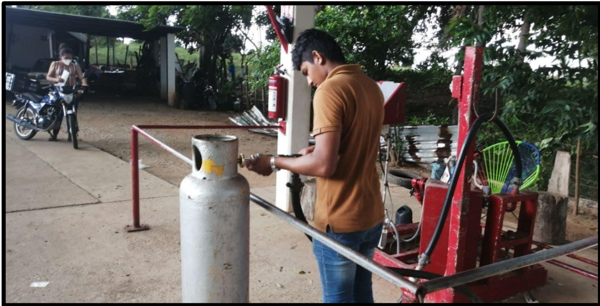
Figura 17 Se muestra como conecta la manguera al tanque
