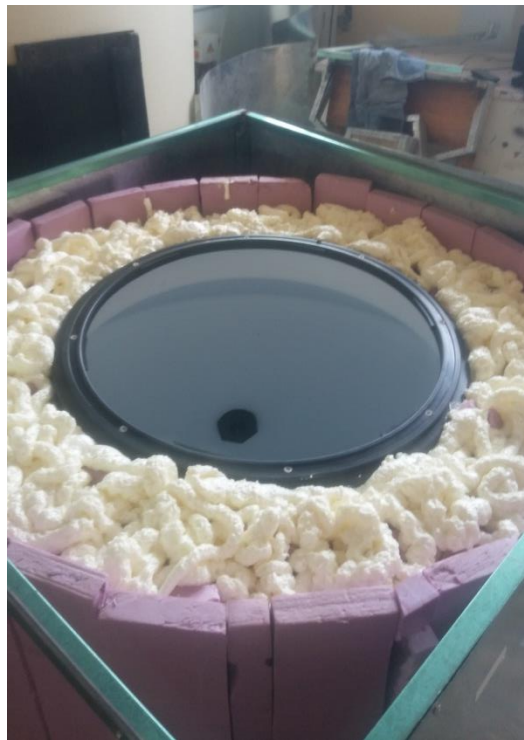
Figura 4.5. Colector solar y termotanque cubiertos con Foamular 250 y espuma de poliuretano (A. Matus, 2019).
