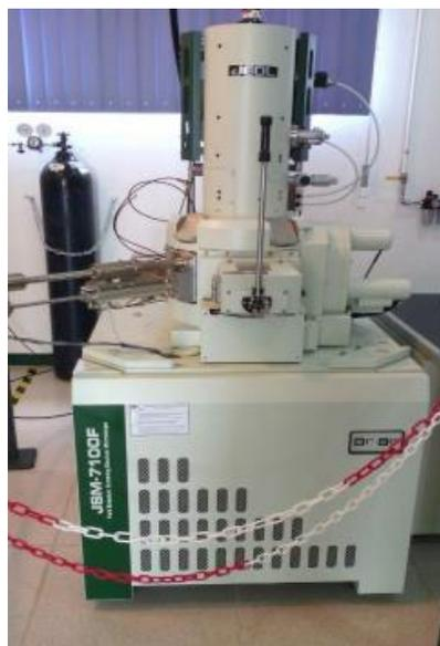
**Figura 11.** SEM marca JEOL modelo JSM-7100F.
