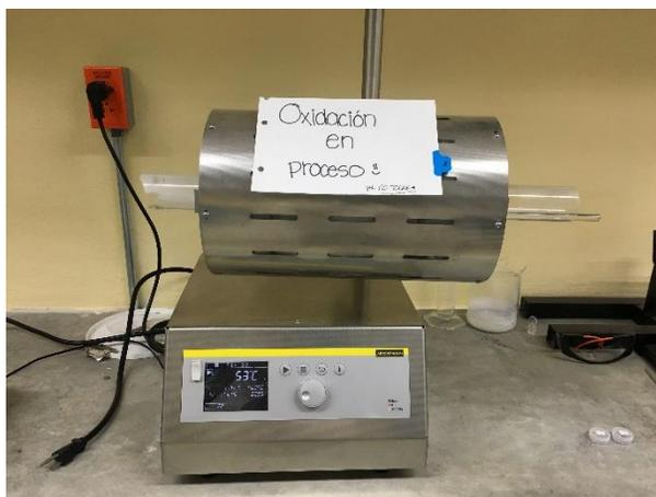
**Figura 9.** Horno tubular marca Nabertherm modelo RT 50/250/11.
