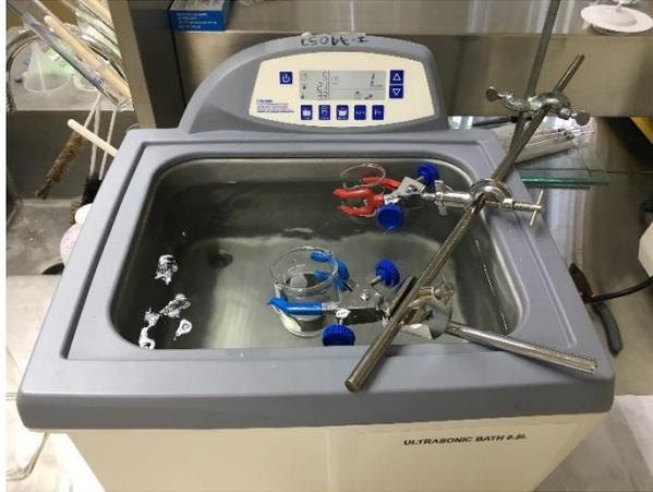
**Figura 8.** Limpieza de un sustrato de GaAs con acetona.
