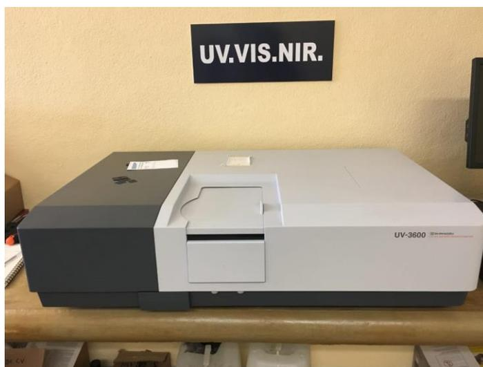
**Figura 12.** Espectrofotómetro UV-VIS-VIR marca SHIMADZU.
