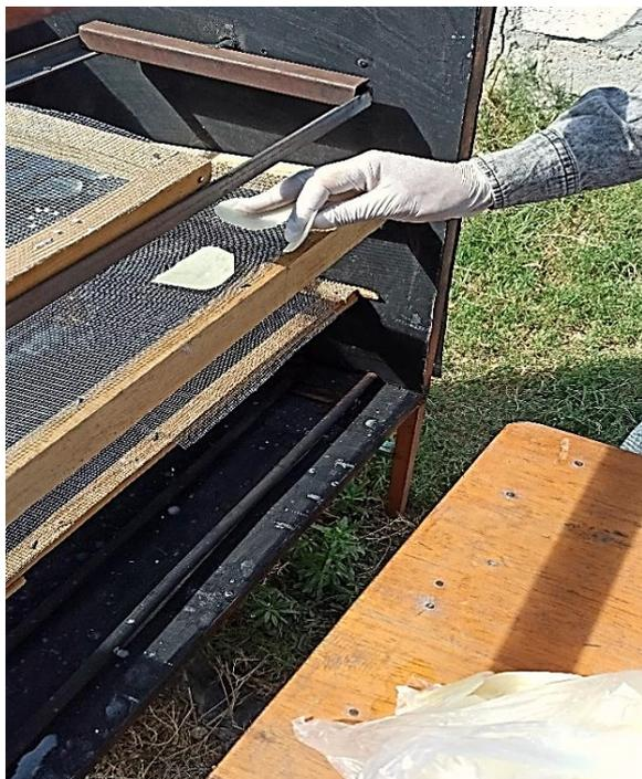
*Figura 56.* Colocando el producto en las bandejas de la cámara de secado.
