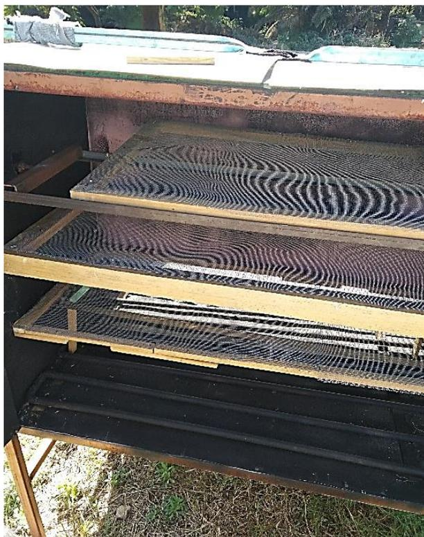
*Figura 25.* Cámara de secado (secador solar indirecto).
