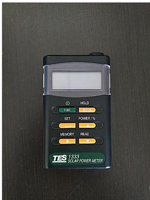
*Figura 23.* Solarímetro.
