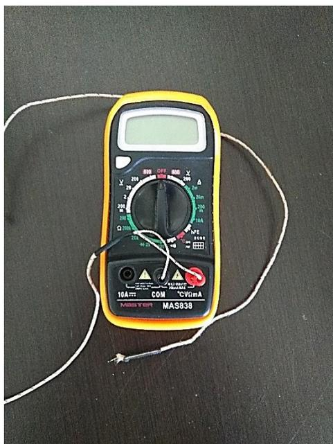
*Figura 22.* Multímetro (termopar).
