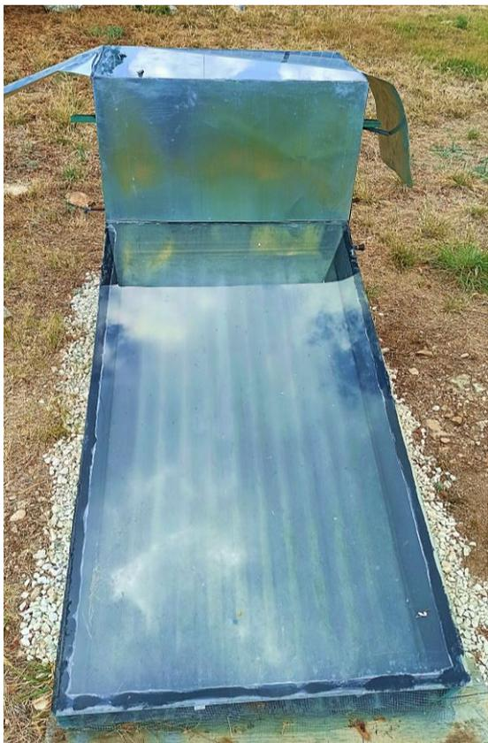
*Figura 19.* Secador solar directo (tipo armario) (visto de frente).
