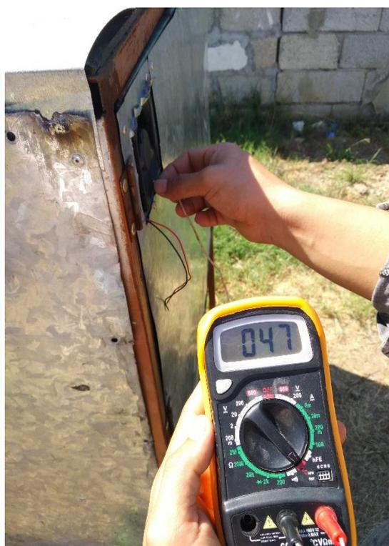
*Figura 36.* Temperatura de la cámara de secado.
