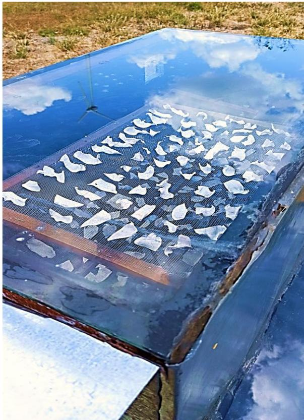
*Figura 20.* Secador solar directo (tipo armario) (visto de arriba).
