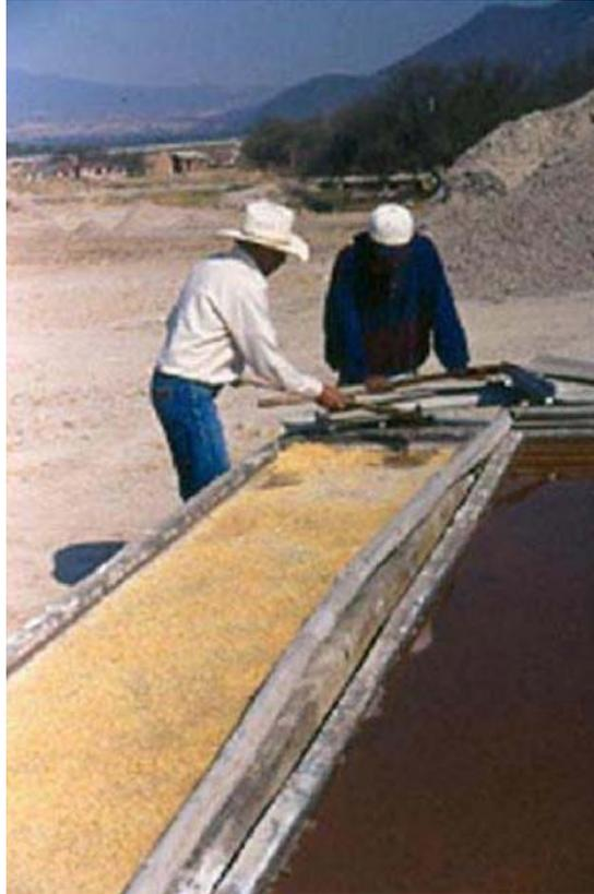
Imagen 5.20. Williams, Eduardo. *Bateas de madera o canoas, usadas en la evaporación solar de las salmueras*. 2005.
