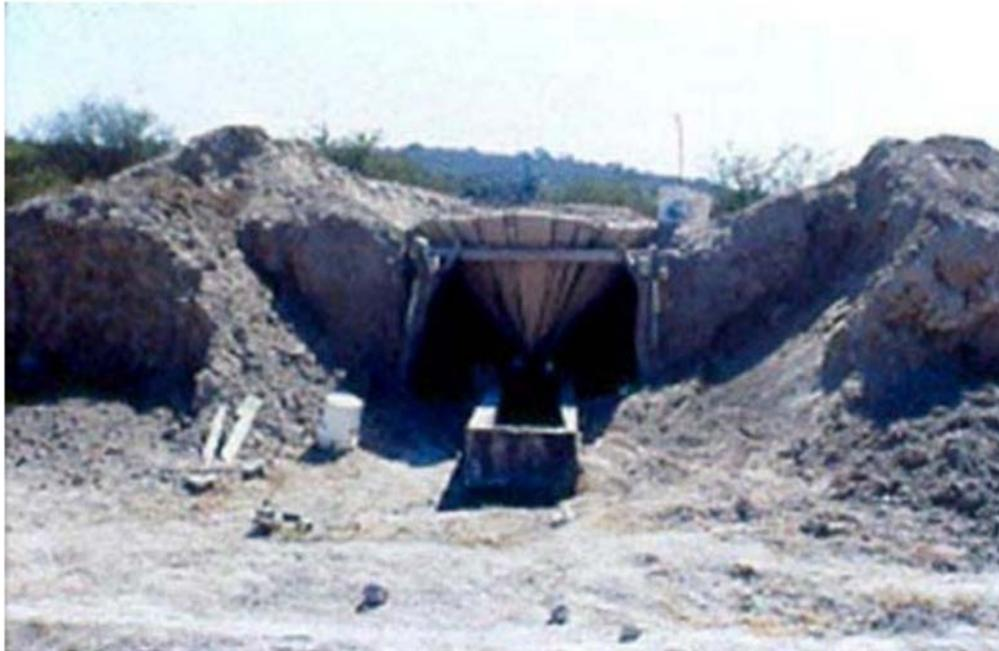
Figura 5.19 *Estiladera de madera, utilizada para extraer salmuera de la tierra mediante la lixiviación.* Williams, Eduardo. La etnoarqueología de la producción de sal en la cuenca del lago Cuitzeo, Michoacán, 2005.
