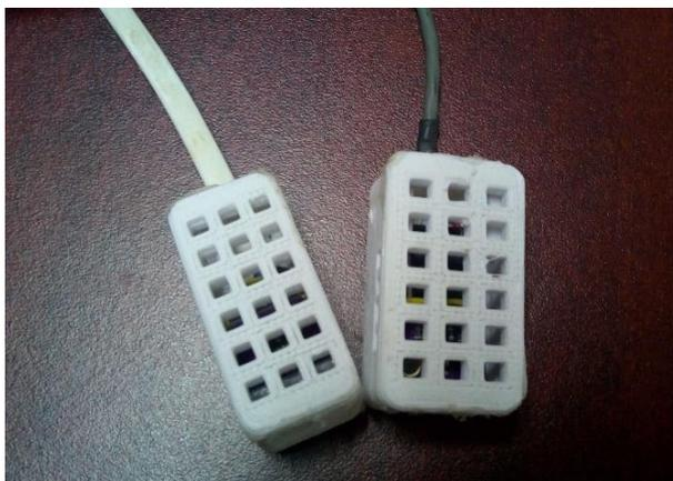
**Figura 27. Sensores BME280 con carcasa.**
