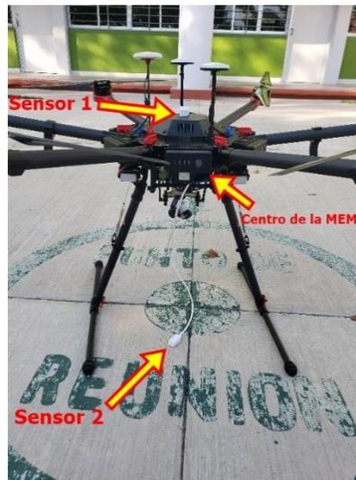
**Figura 32. Montaje de la MEM sobre el VANT.**
