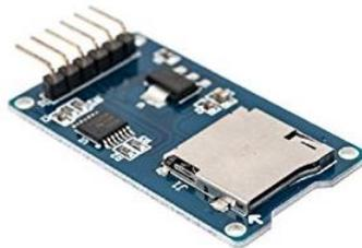
**Figura 13. Módulo socket tarjeta SD (Herrero, 2019).**
