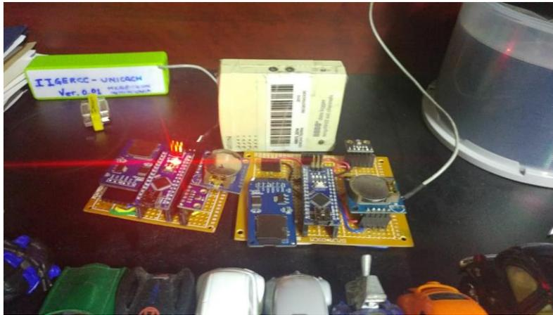
**Figura 15. Prueba de funcionamiento de la MEM vs HOBO.**
