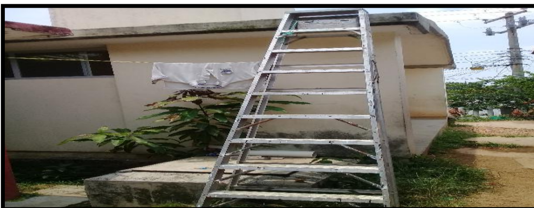
Figura 25.Escalera mal posicionada parte derecha de la institucion Fuente: Con base a la información obtenida.
