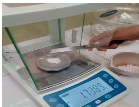
Figura 13. _ Peso de la muestra para determinar calcio en la cascara de huevo.
