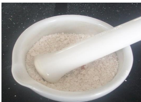
Figura 12. _ Trituración de la cascara de huevo en el mortero.
