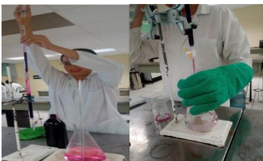
Figura 14. _ Titulación de determinar calcio en la cascara de huevo.
