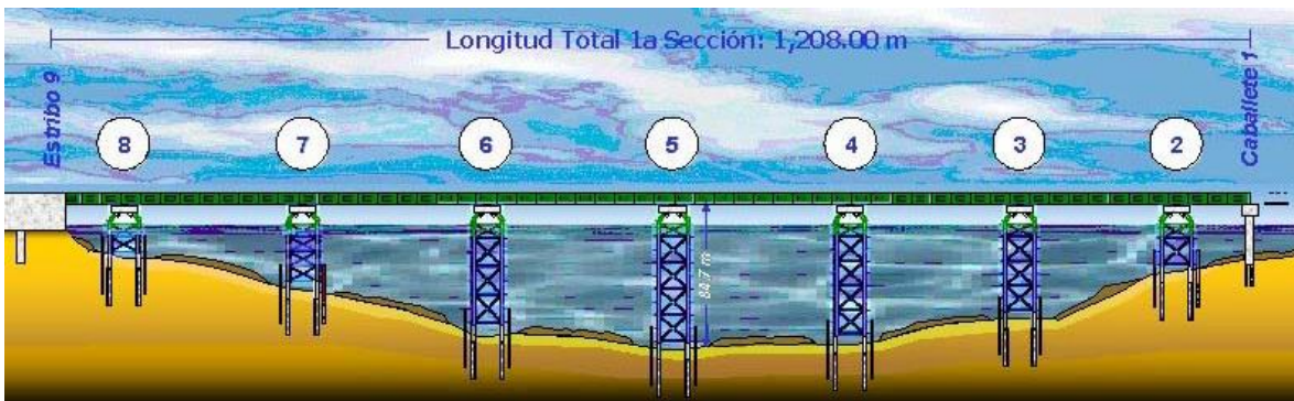
Imagen 4.3.2-2 Subestructura de 7 Jackets
