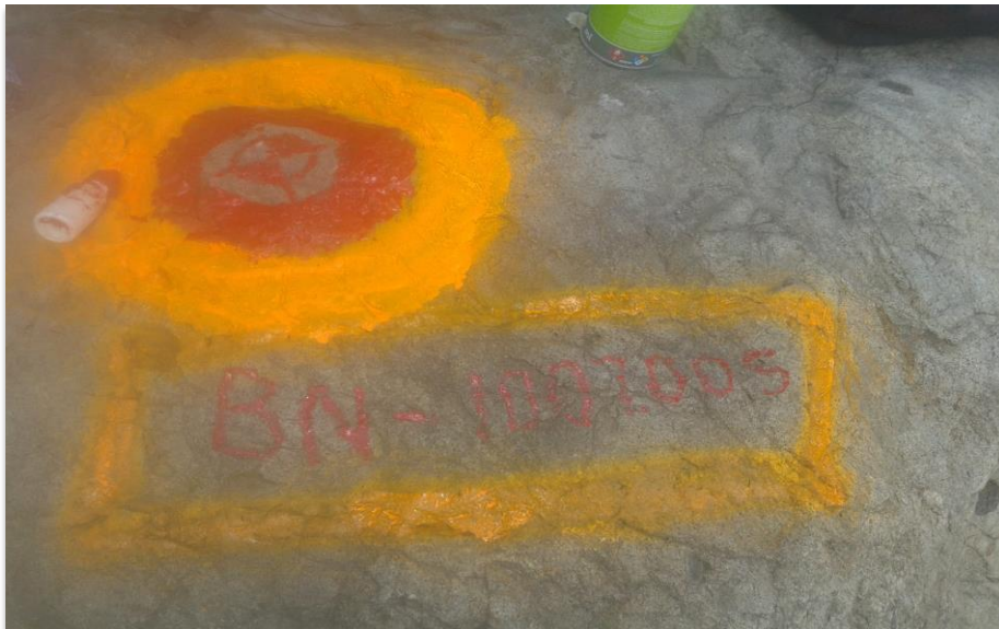
Imagen 2.2-3 BN 01 Ubicado sobre Roca a 39,60m lado derecho, estacion 21+283.92; Elev.= 1007.005m
