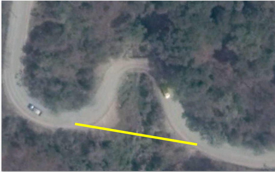
Imagen 3.1-1 Se muestra el Eje Nuevo del Puente que se Reconstruirá
