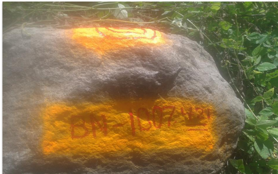
Imagen 2.2-4 BN 02 Ubicado sobre Roca a 32.90m lado derecho, estacion 21+307.34; Elev.= 1007.421m
