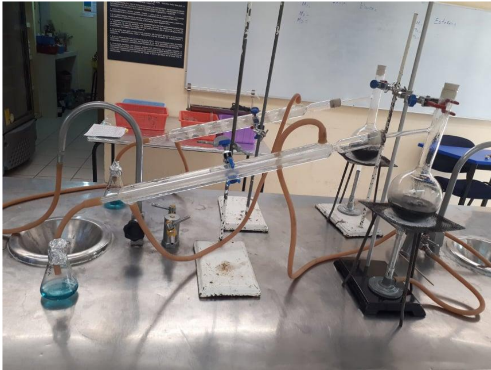
Figura 40. Destilación de fenogreco.
