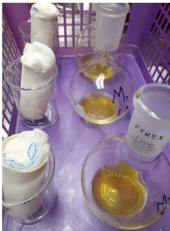
Figura 34. Muestra de cartucho sin grasa y embudos de cuellos con grasa.
