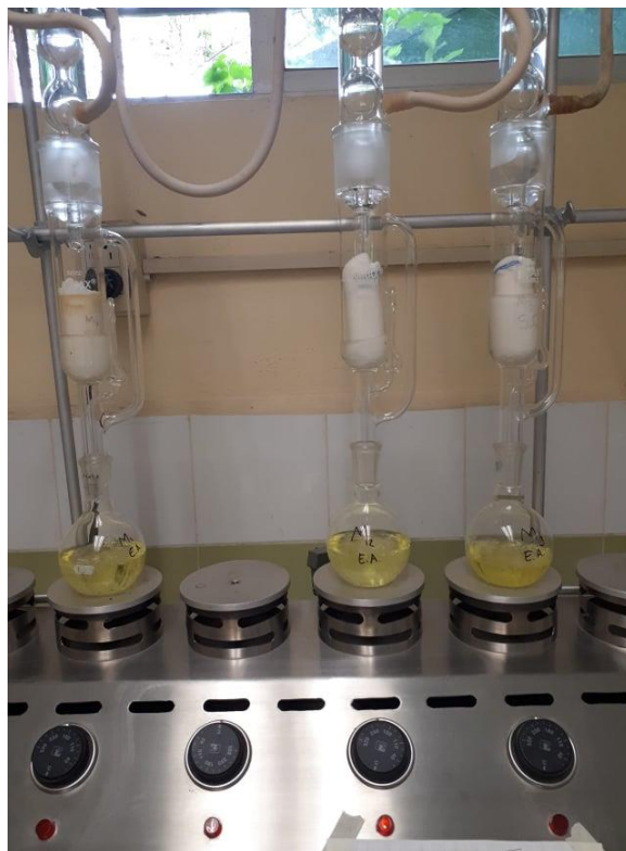
Figura 31. Proceso de extracción de grasa.
