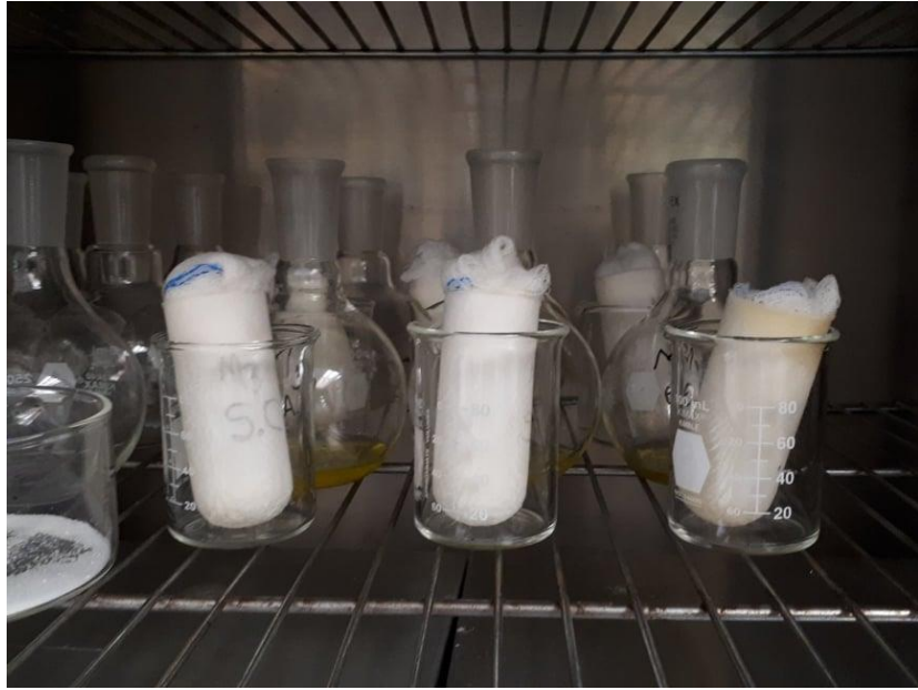
Figura 35. Cartuchos y grasa en horno de secado.
