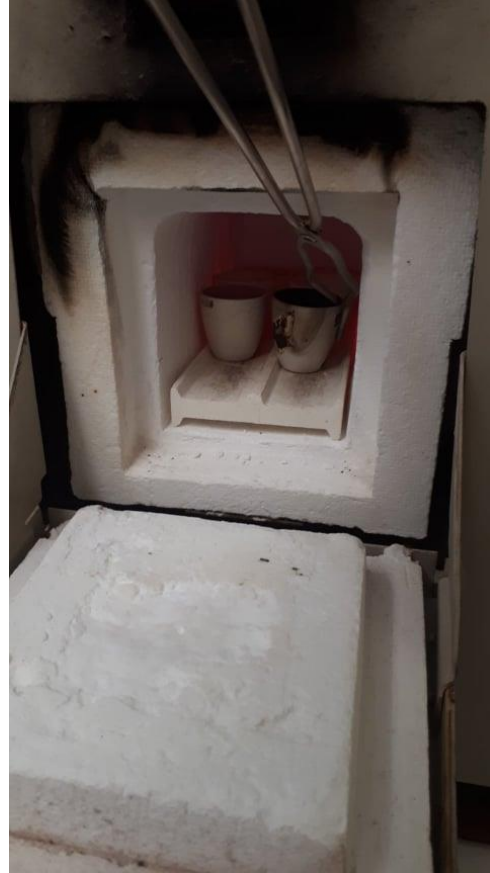
Figura 24. Semilla de fenogreco quemado en parrilla. Figura 25. Semilla quemada en mufla.
