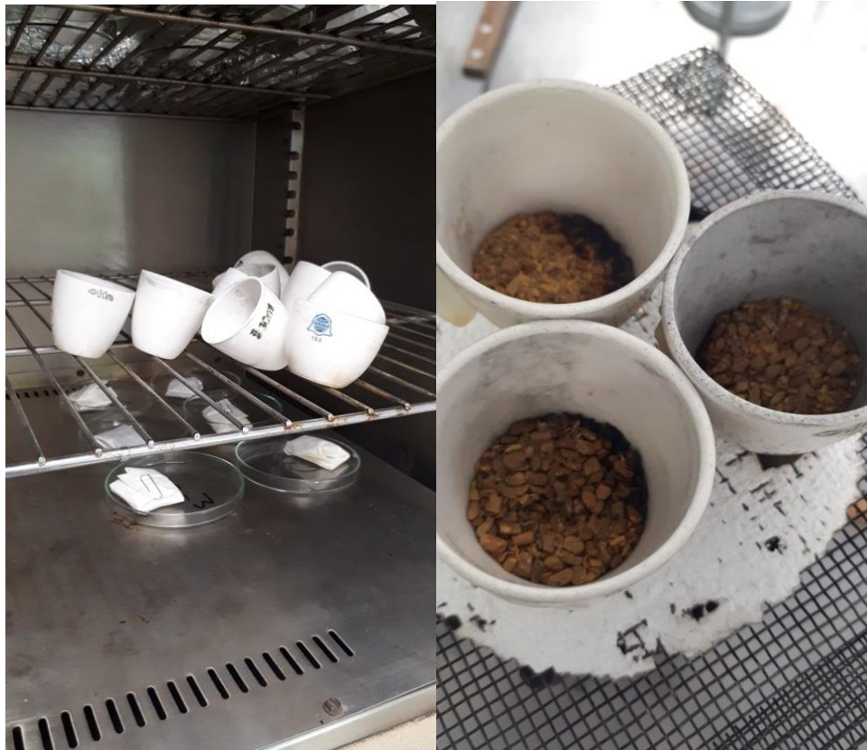
Figura 21. Determinación de cenizas proceso de secado y quemado.
