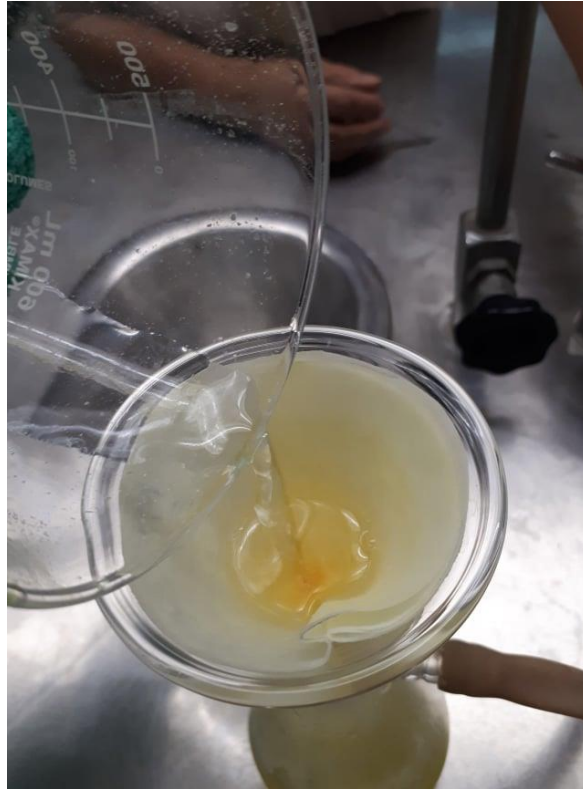
Figura 50. Colocación de acetona.
