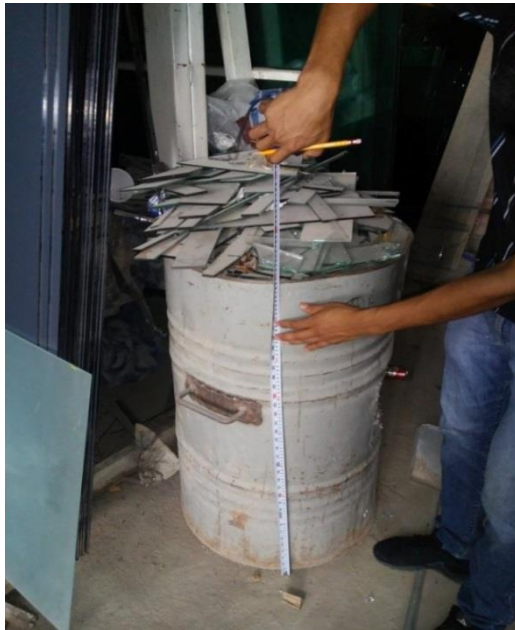
Imagen 7. Medición de residuo con contenedor de lámina en una de las tiendas del estrato 11 a 30 (elaboración propia)
