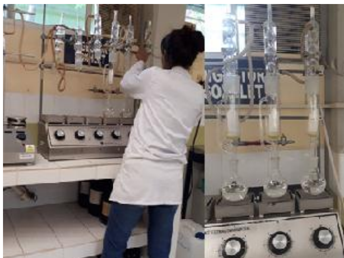
Figura 31. Colocación de muestras en equipo de extracción Soxhlet (Tecauatzin, 2019).
