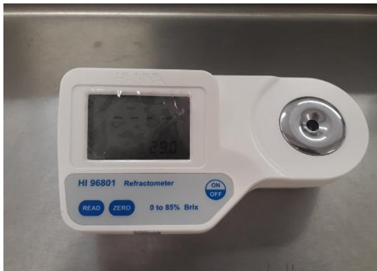
Figura 48. Refractómetro para medir grados Brix del concentrado (Tecuautzin, 2019).
