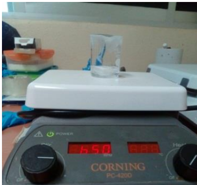
Imagen 7. Agitación de etanol más Rutenium (II) Dichlorides y TEOS a 650 rpm durante 25 min.
