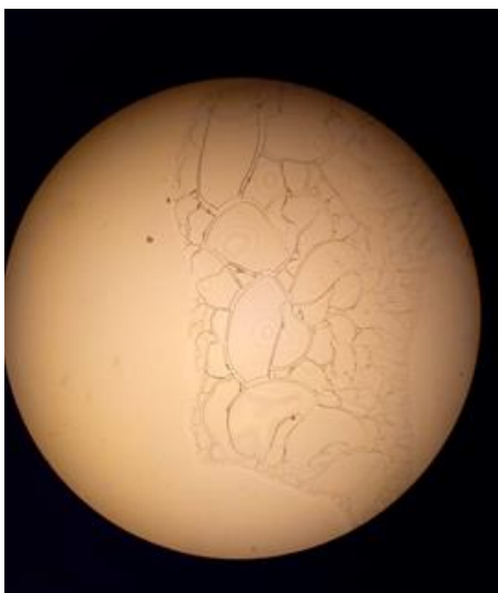
Imagen 13. Matriz Sol-Gel con 3mg de Rut (II) de 3 inmersiones a 10 x.
