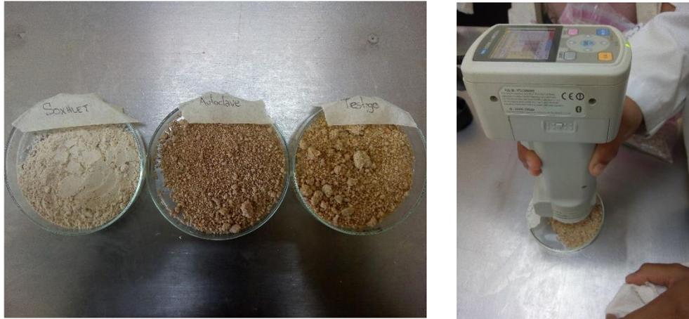
Figura 15. Determinación de color a testigo y dos tipos de tratamiento de la Harina.
