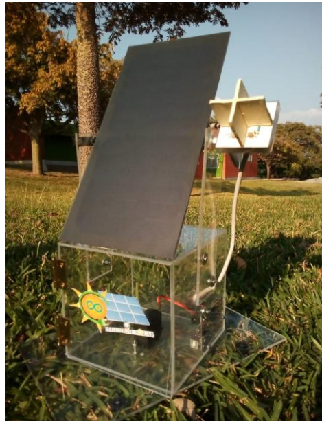
Figura: 19 Seguidor solar Fotovoltaico. (Cancino, 2018)
