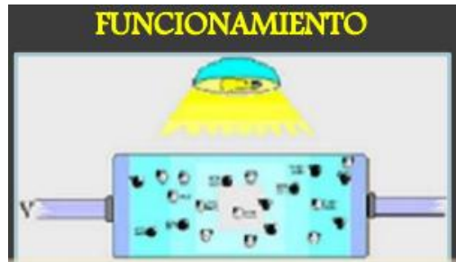
Figura: 17 Funcionamiento de las Resistencias LDR. (TECNOLOGÍA, 2016) (Cancino, 2018)
