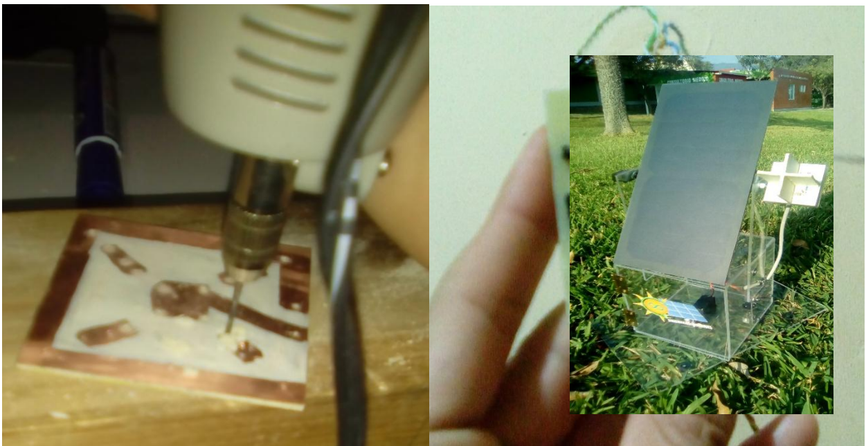
Al finalizar el circuito se colocara en la Figura: 24 Orificio de la placa y colocación de cables. (Cancino, 2018)
