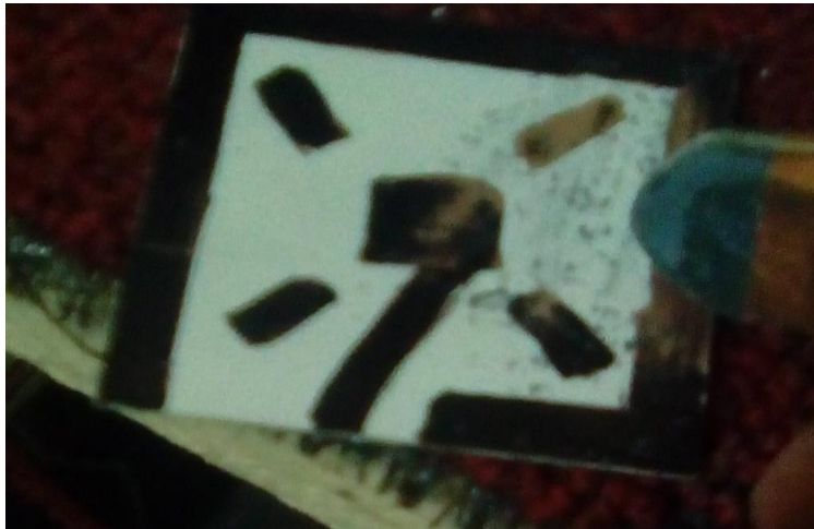
Figura: 23 Placa de cobre ya oxidado con el Cloruro Férrico. (Cancino, 2018)
