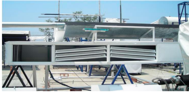
Figura 1.8 Deshidratador Solar Combinado Térmico-Fotovoltaico, Vista frontal del túnel de secado [21].
