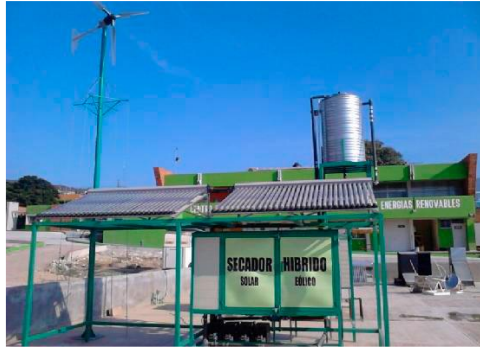
Figura 1.11 Secador Híbrido Solar Eólico automatizado [18]
