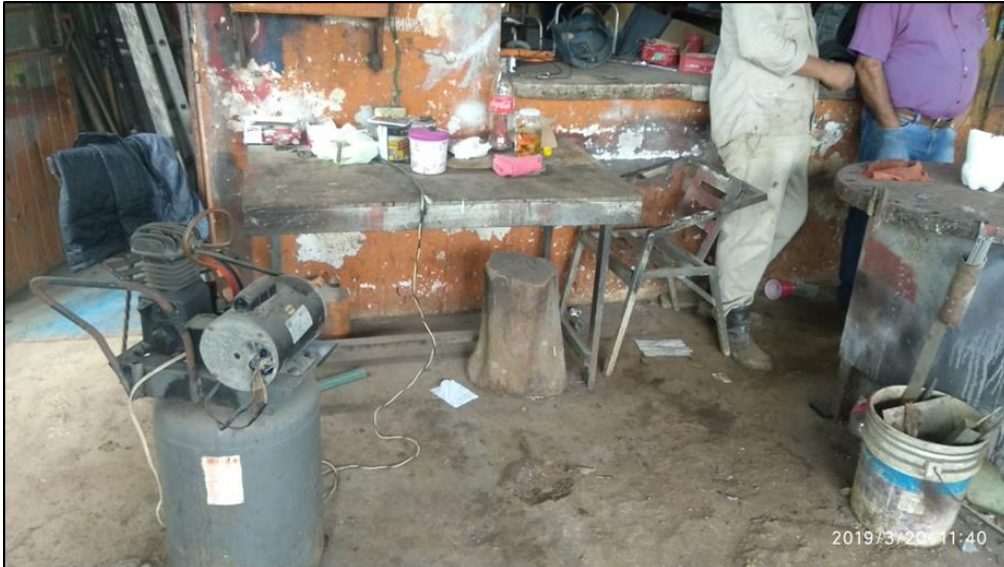
Ilustración 18 Herrería “Hermanos Rincón”, Cableado sobre mesas con sustancias. Fuente: Con base a la información obtenida
