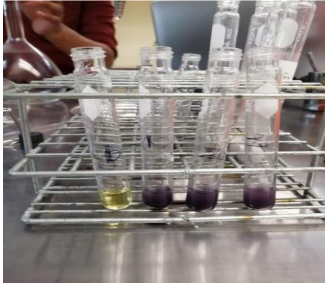
Figura 18 Determinación de prueba de lugol para el almidón de plátano macho en estado de madurez 2.
