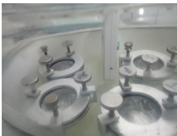
Figura 22 Acondicionamiento de películas comestibles para determinar la permeabilidad al vapor de agua.
