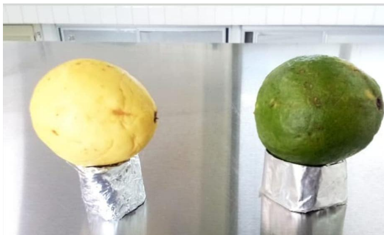
Figura 24 Comparación entre una Guayaba sin recubrir y una Guayaba recubierta con almidón de plátano macho/ quitosano (50:50) durante 10 días de almacenamiento a condiciones ambiente (25 a C /50%HR).
