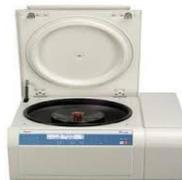
Centrifuga: separa los fluidos de mayor densidad sedimentándolos y los de menor densidad dejándolos sobre la superficie.
