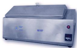
Baño María: sirve para calentar muestras de manera indirecta o para mantenerlas en una temperatura constante.
