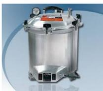
Autoclave: sirve para la esterilización de materiales y equipos.
