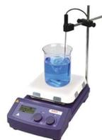
Agitador magnético: sirve para agitar las muestras y/o calentarlas.
