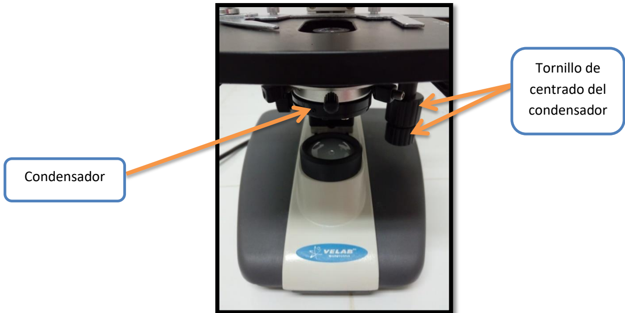
Figura 3. Partes de un microscopio óptico (vista frontal inferior).
