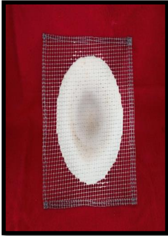
Tela de asbesto
