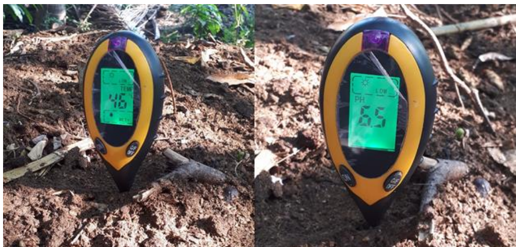
Figura 13. Medición de temperatura, humedad y pH con el medidor marca OEM - fuente: Gómez, 2019
