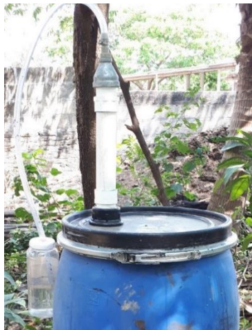
Figura 3. Finalización de la elaboración del biodigestor - fuente: Gómez, 2019
