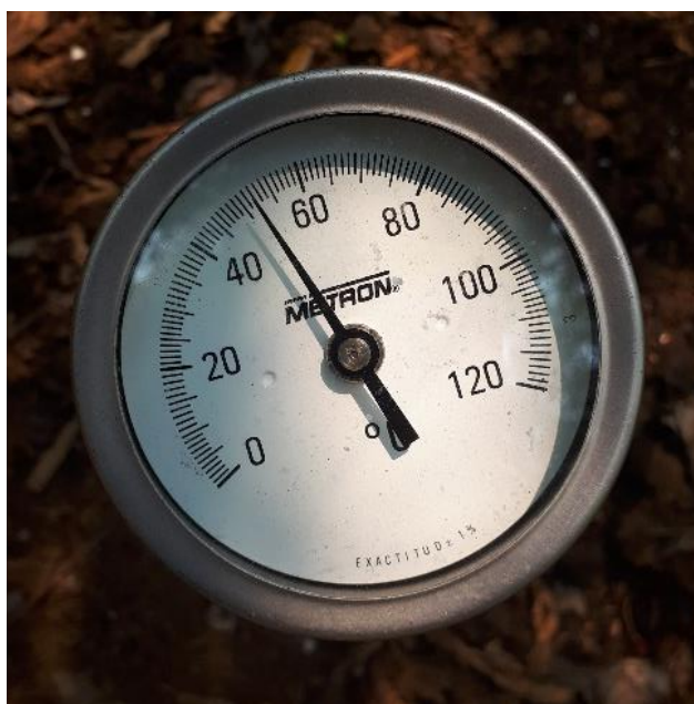
Figura 14. Medición de temperatura con el medidor marca Metrón - fuente: Gómez, 2019
