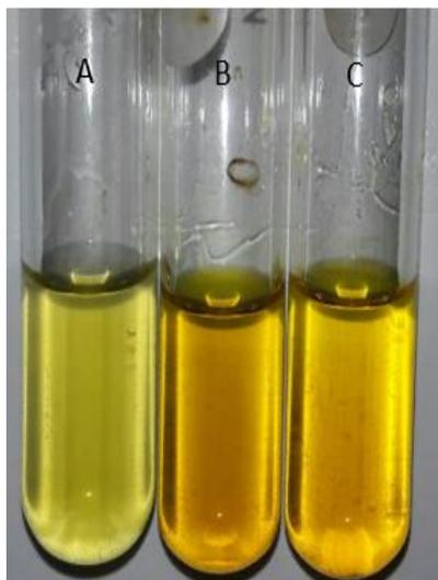
Figura 22.- Prueba de Baljet. A=control 1 (extracto+agua), negativa B= extracto+reactivo, positiva y C= control 2 (agua+reactivo), negativa.
